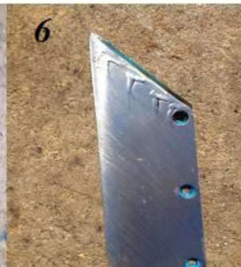
Рис. 2. Схемы наплавления лемеха плуга 3352134SB56D Lemken
