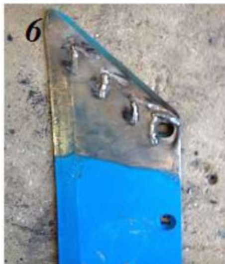
Рис. 2. Схемы наплавления лемеха плуга 3352134SB56D Lemken
