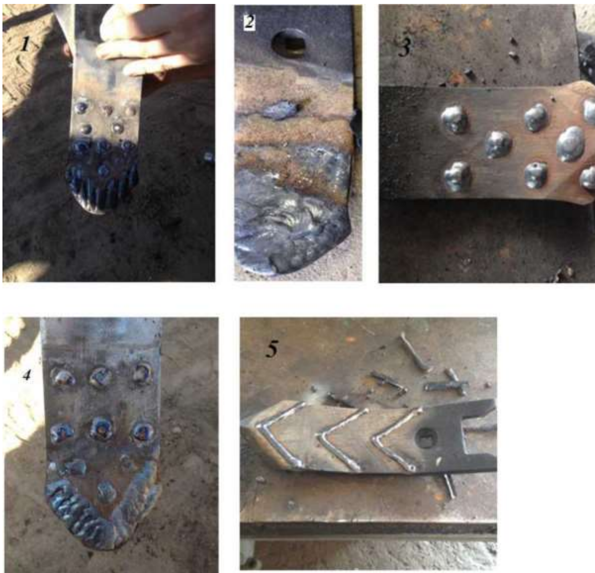
Рис. 1. Схемы наплавления твердых покрытий на долото культиватора Horsch - 34060850-U (1 - наплавление точек на тело долота и валиков на рабочую кромку; 2 - сплошное наплавление тела долота до середины детали; 3 - наплавление точек в шахматном порядке; 4 - наплавление точек на тело долота и сплошное наплавление рабочей кромки; 5 - V - образное нанесение валиков на тело долота)
