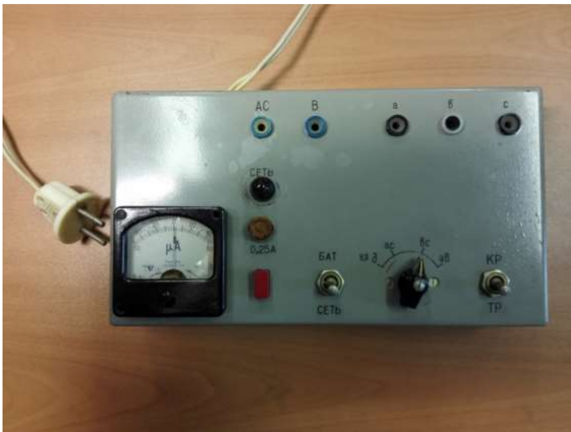
Рис. 6. Фотография разработанного портативного прибора для определения группы соединения обмоток и снятия круговых диаграмм переключателей трансформаторов
