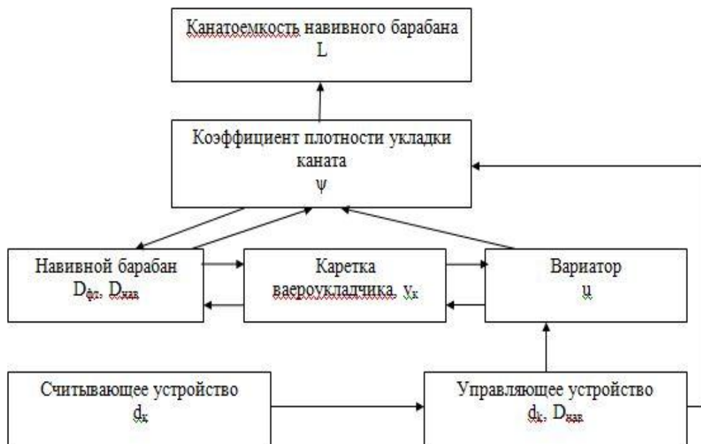
Рис. 2. Алгоритм управления укладочным устройством траловой лебедки
