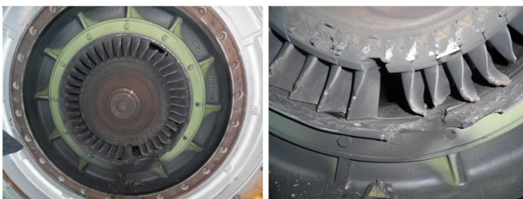
Рис. 9. Повреждения турбинной части ТК
