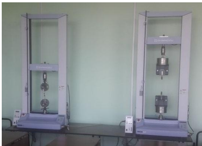
Рис. 1. Универсальные разрывные машины Shimadzu Autograph AGS-X10
