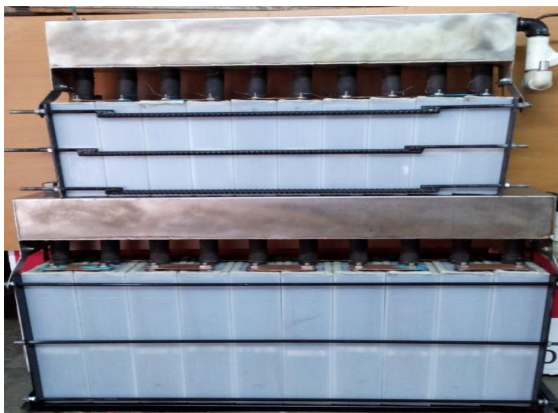
Рис. 1. ЭВГ производительностью 600 и 900л газовой смеси в час
