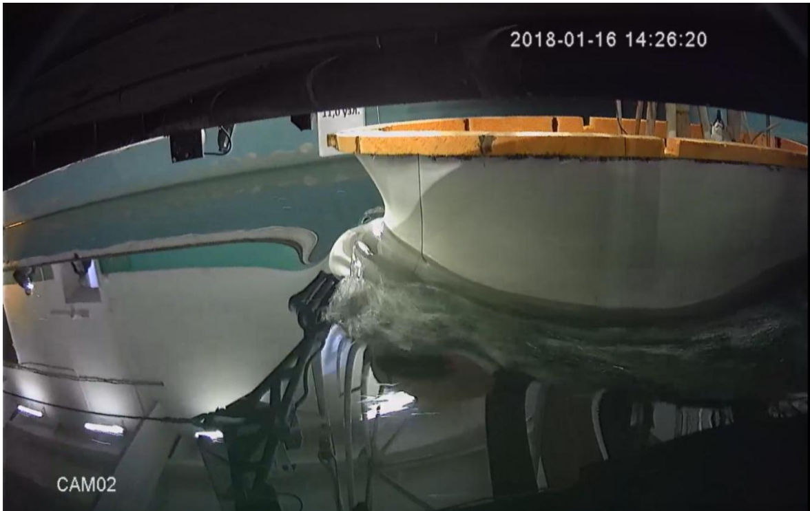
Рис. 10. Вид сбоку (форштевень) в 3 случае нагрузки. Скорость 11 узлов
