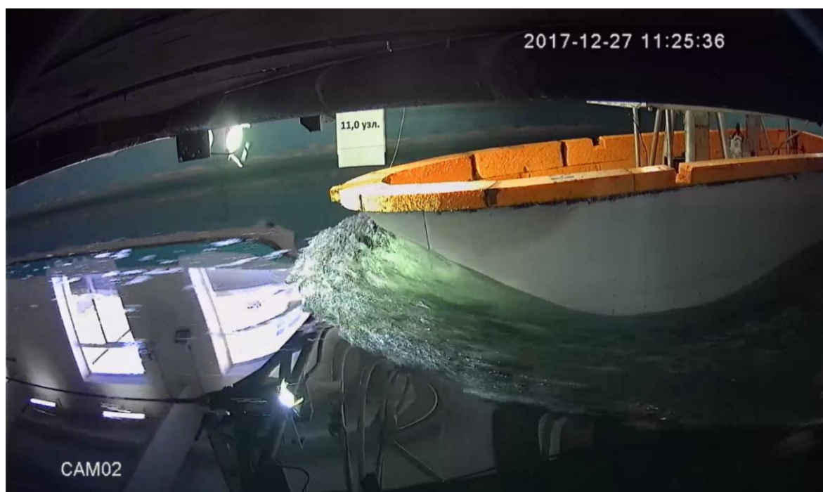
Рис. 8. Вид сбоку (форштевень) в 1 случае нагрузки. Скорость 11 узлов
