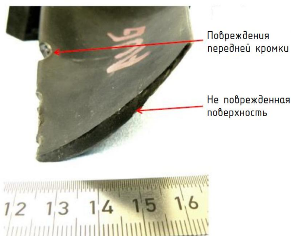
Рис. 10. Повреждения турбинной лопатки №2
