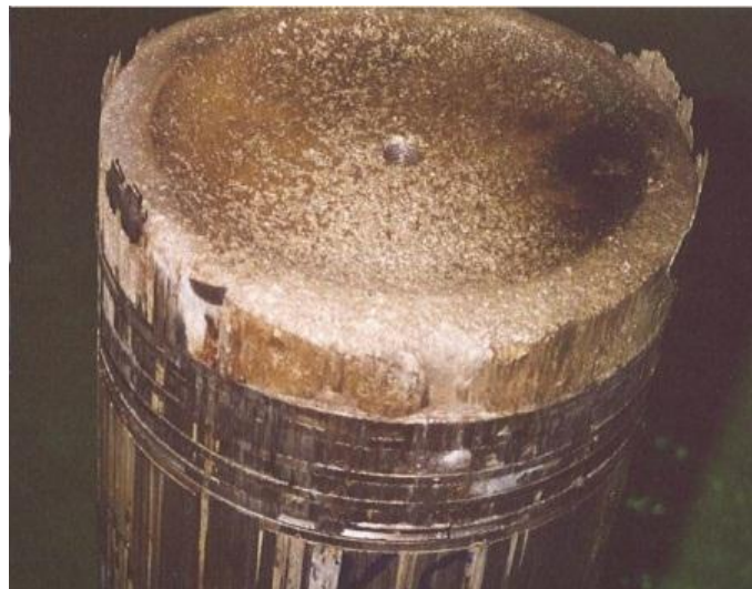
Рис. 6 Эрозионные повреждения поршня от неконтролируемого сгорания газа в цилиндре
