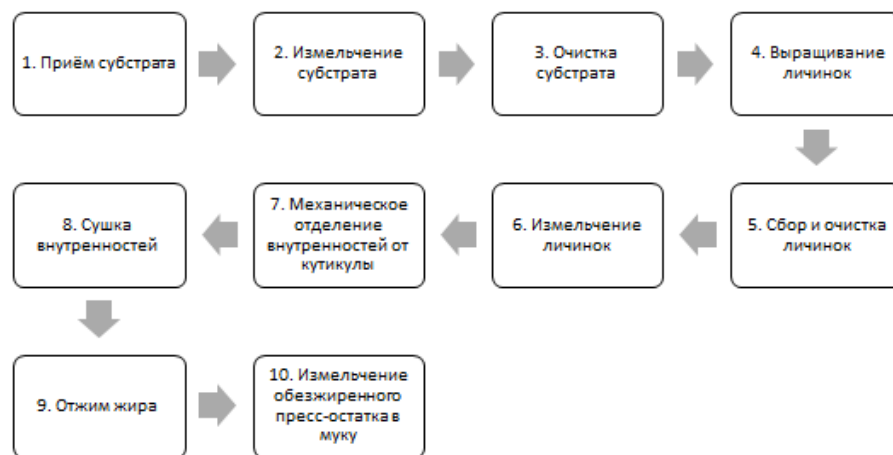
Рис.3 . Блок схема переработки насекомых в протеиновую муку.
