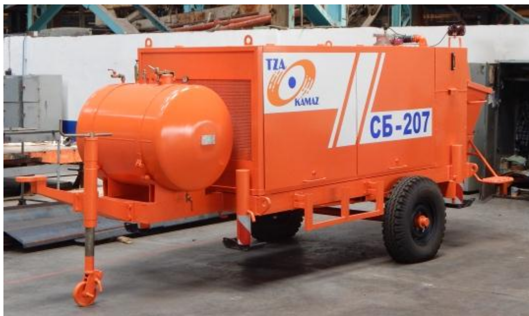
Рис. 3. Стационарный поршневой бетононасос BN 20E (СБ-207) [15]
