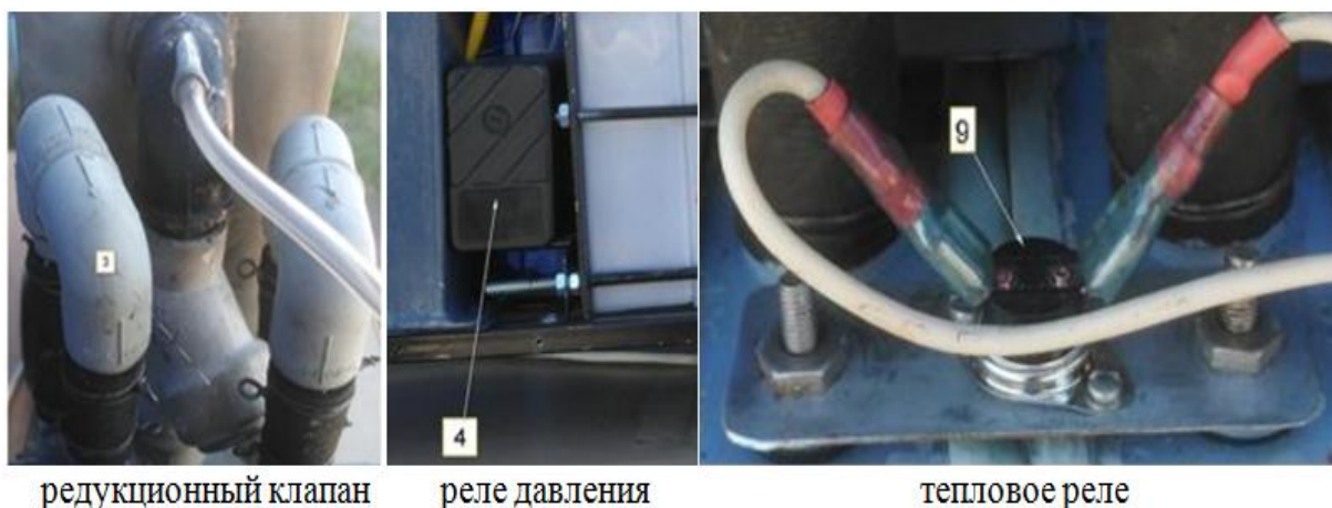
Рис.5. Элементы системы автоматики
