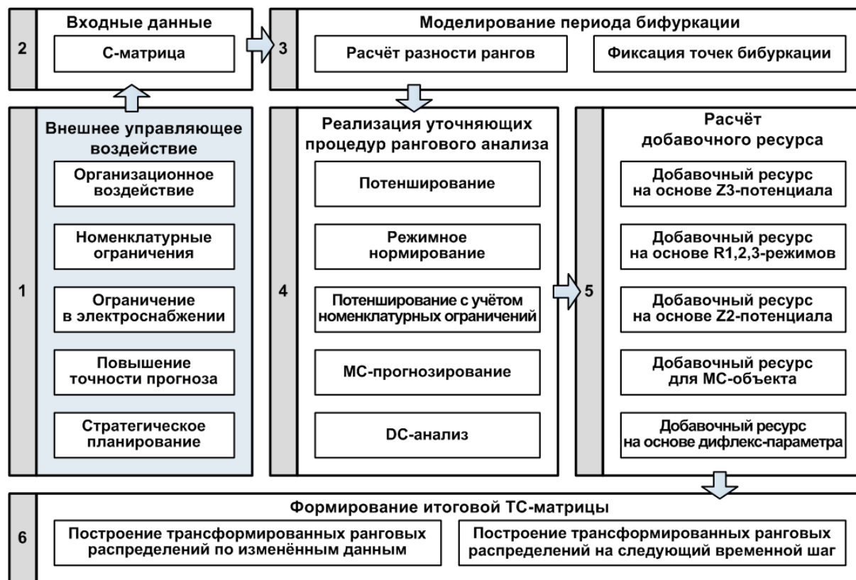
Рис. 9. Структура динамической модели управления электропотреблением
