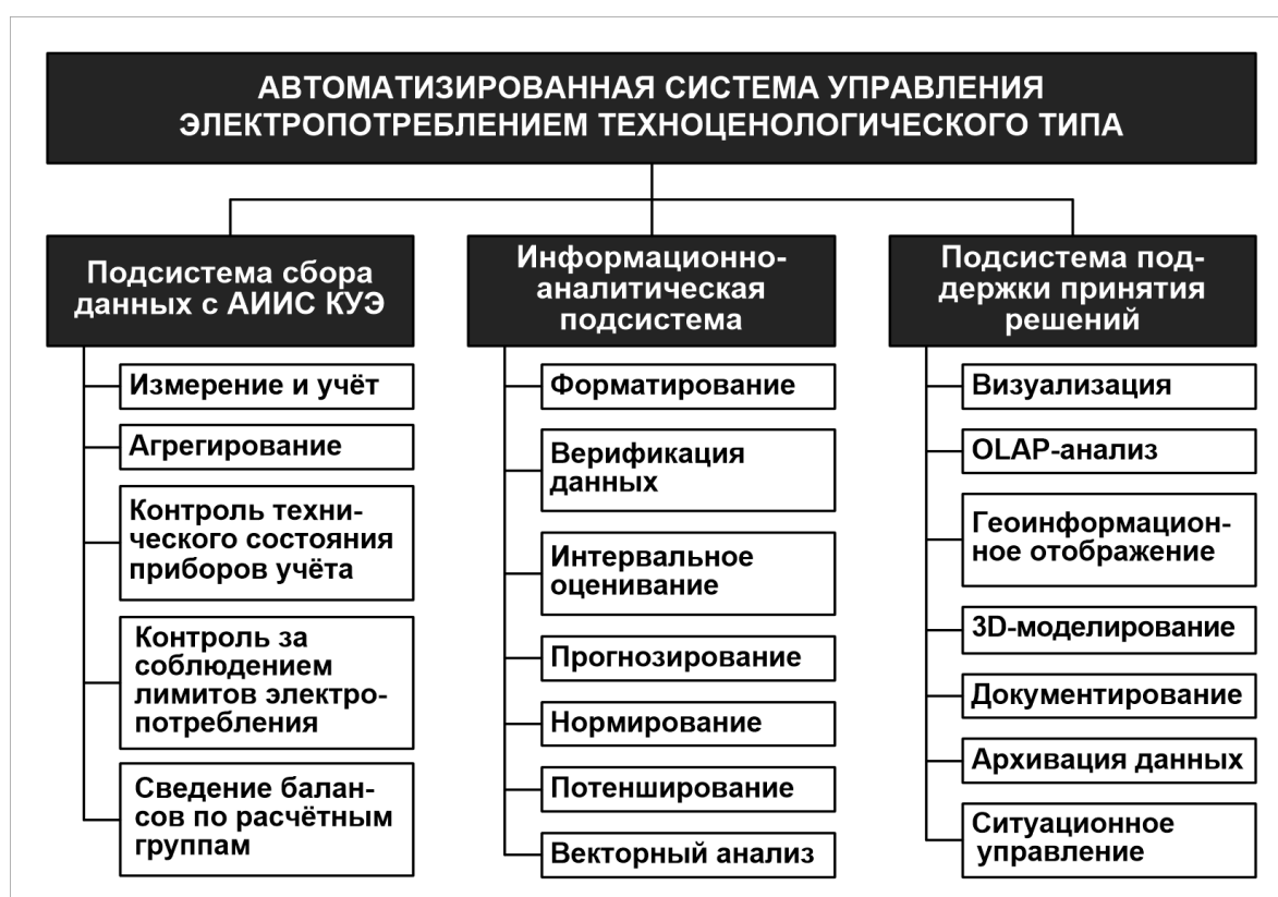
Рис. 1. Основные подсистемы автоматизированной системы управления электропотреблением техноценологического типа
