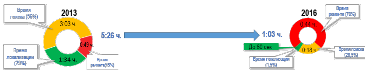
Рис. 4. Снижение времени восстановления электроснабжения, ч
