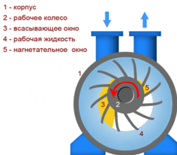
Рис. 3. Принципиальная схема водокольцевого вакуумного насоса [10]
