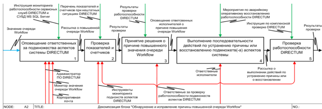
Рис. 4. Декомпозиция блока A2 «Обнаружение и исправление причины повышенной очереди Workflow»
