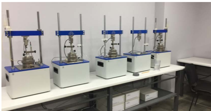
Рис. 2. Устройство осевого нагружения кинематическое ГТ 2.0.5 с одометрами
