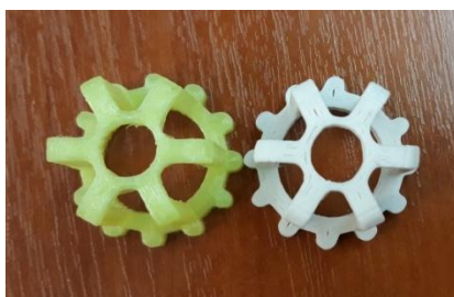
Рис. 4 Защитные колпачки из SBS-пластика (слева) и PLA-пластика (справа)
