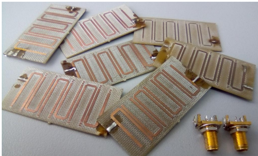
Рис 8 Фильтры Ф-1.0, Ф-1.1, Ф-1.2 и SMA-разъёмы 50 Ом
