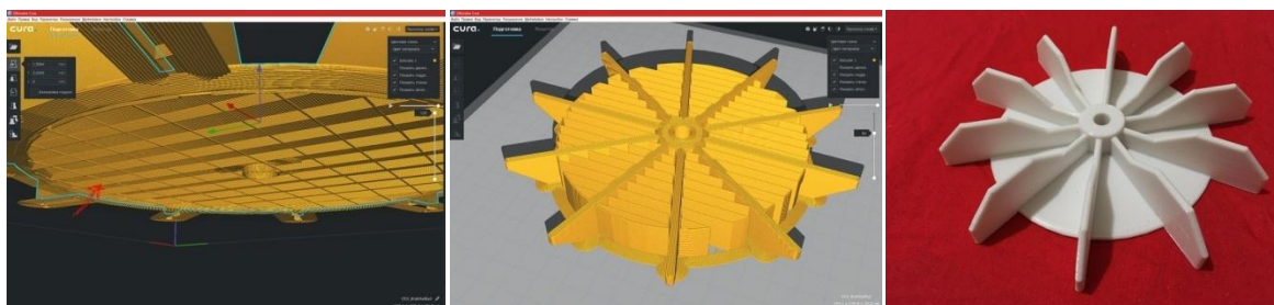
Рис. 5 Второй вариант изготовления крыльчатки (слева), третий вариант (по центру) и напечатанный образец по четвертому варианту (справа)
