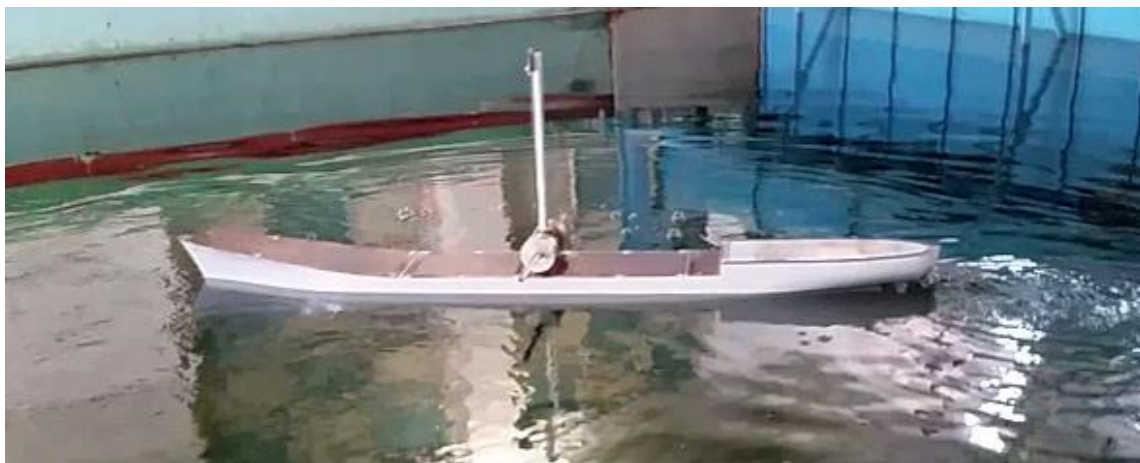
Рис. 1. Общий вид самоходной модели с седловатостью палубы
