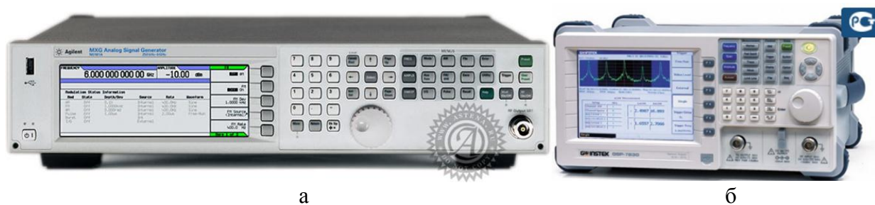
Рис.6 Приборы измерительного стенда, а – генератор; б – анализатор спектра.
