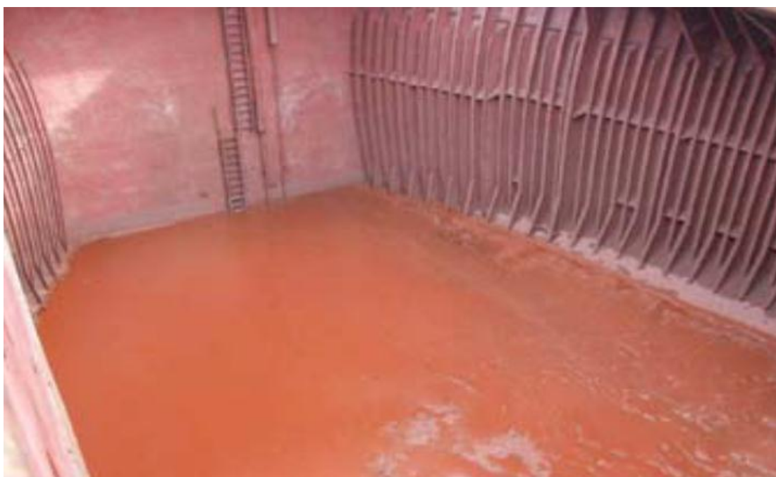
Рис. 3 Железная руда (Iron Ore Fines) после разжижения в трюме
