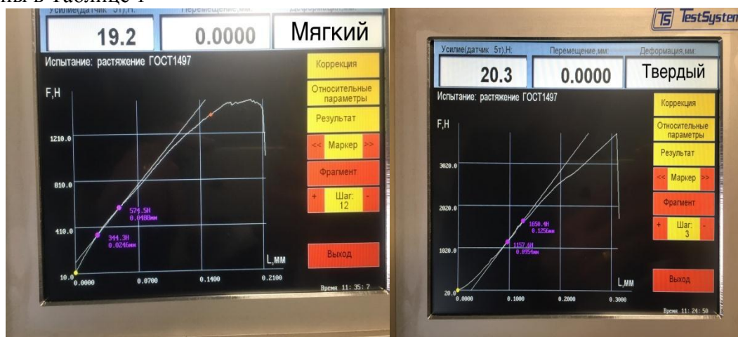
Рис.6 Диаграммы растяжений образцов паянных мягким и твердым припоями.
