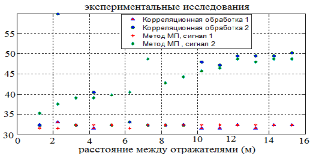
Рис.4 Оценки дальности до первого и второго углового отражателя
