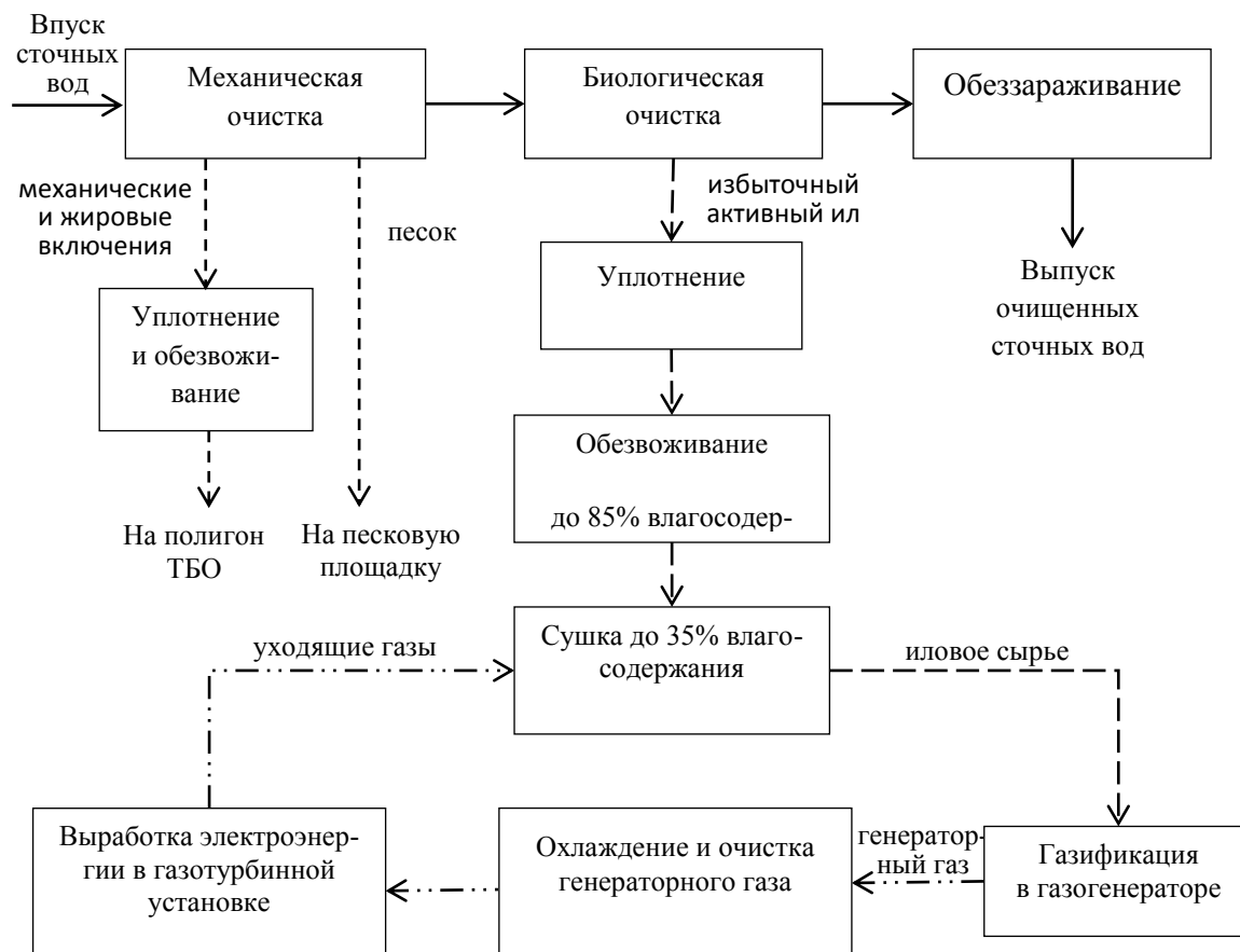
Рис. 4 Структурная схема теплоэнергетической системы канализационных очистных сооружений с газотурбинной установкой
