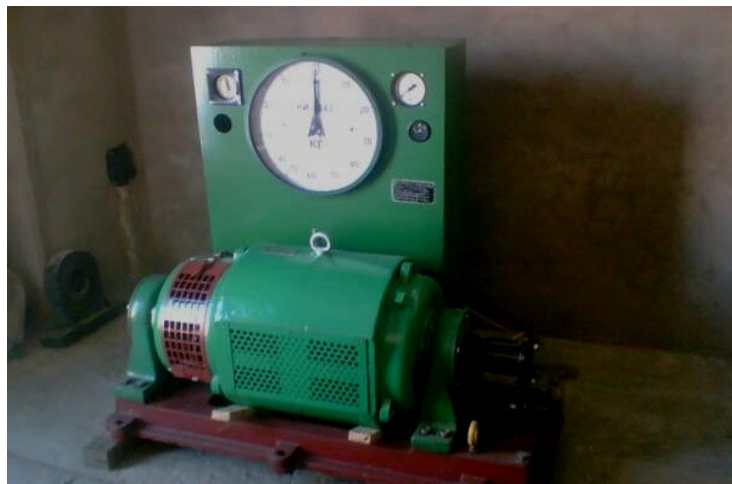
Рис.1 Балансирная электрическая машина с весовым индикатором для определения крутящего момента
