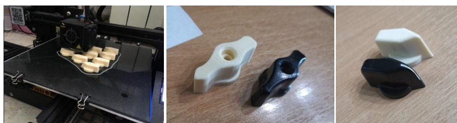
Рис. 6 Процесс печати с расположением изделий на платформе (слева), первый вариант образцов (по центру) и второй вариант образцов (справа)
