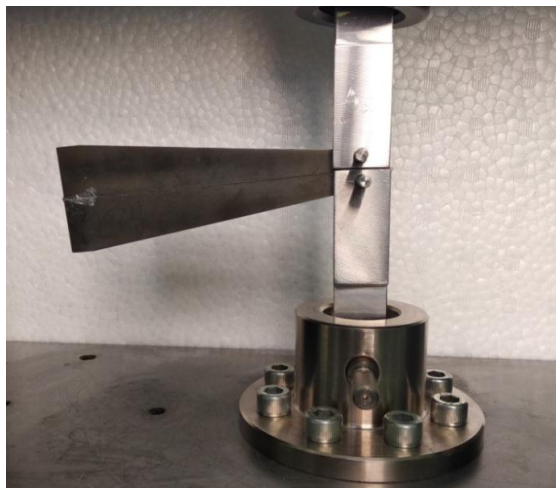
Рис. 1 – Испытания клеевой балки на трещиностойкость
