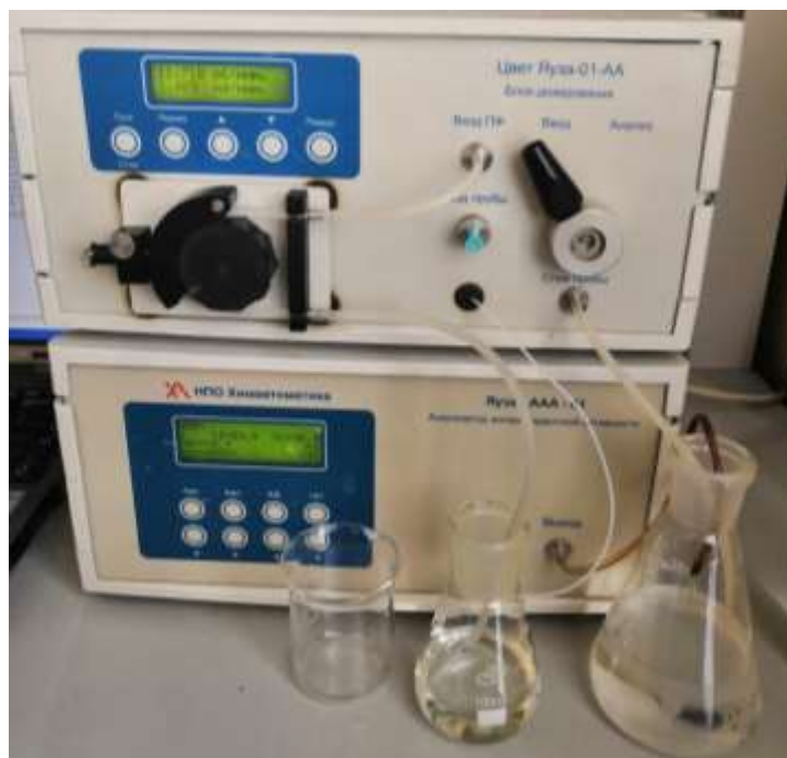
Рис.3. Прибор «ЦветЯуза-01-АА» с амперометрическим детектором, в процессе получения градуировочного графика
