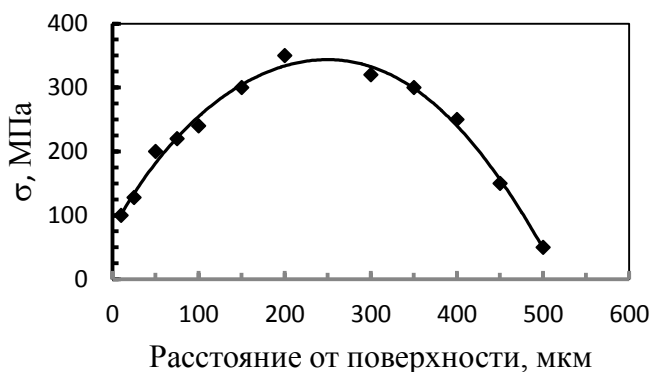
Рис. 2 Распределение остаточных сжимающих напряжений по глубине азотированного слоя стали 38ХМЮА
