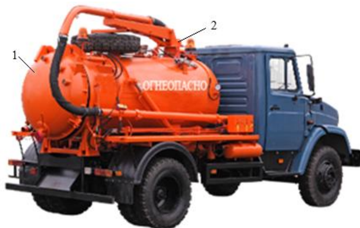
Рис. 2 Общий вид установка вакуумной откачки отходов высоковязких нефтепродуктов УВО-1 [7]: 1 – цистерна, 2 – люк для присоединения рукава
