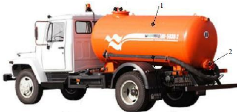
Рис.1. Общий вид канализационной установки КО-503В на базе автомашины ГАЗ-3307 [6]: 1 – цистерна, 2 – люк для присоединения рукава
