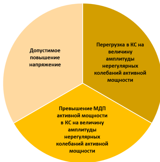
Рис. 2 Возможные нарушения нормального режима электрической части энергосистем
