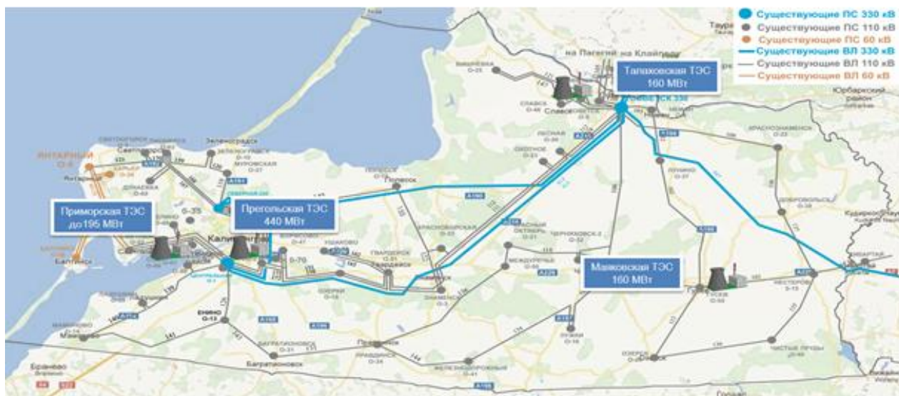
Рис. 2 Электроэнергетическая система Калининградской области
