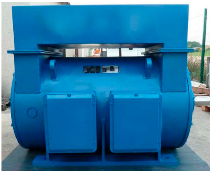
Рис. 7. Внешний вид генератора на постоянных магнитах фирмы EMG-EMCO
