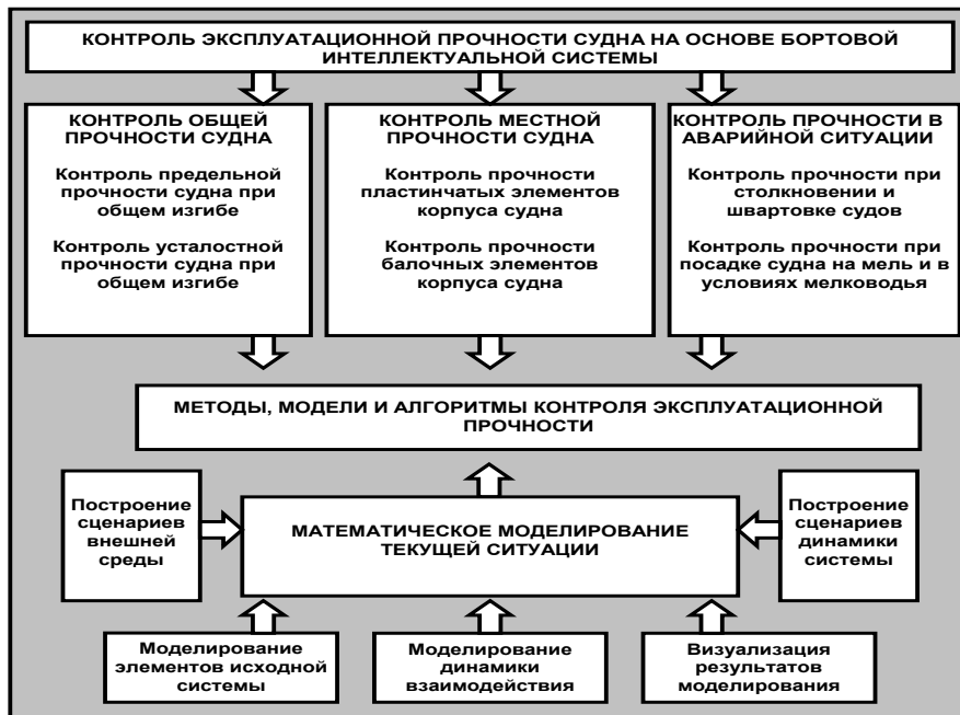
Рис. 1. Концептуальная модель бортовой интеллектуальной системы контроля эксплуатационной прочности
