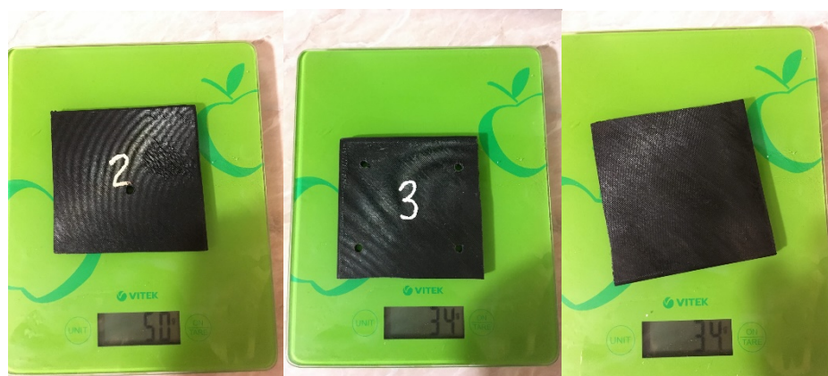
Рис. 4. Определение массы образцов (№2, №3, №4) после завершения испытаний
