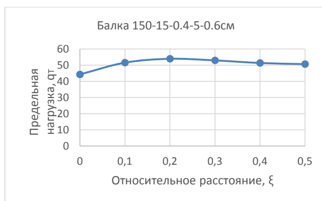
Рис.6. Зависимость предельной нагрузки от положения выреза по длине
