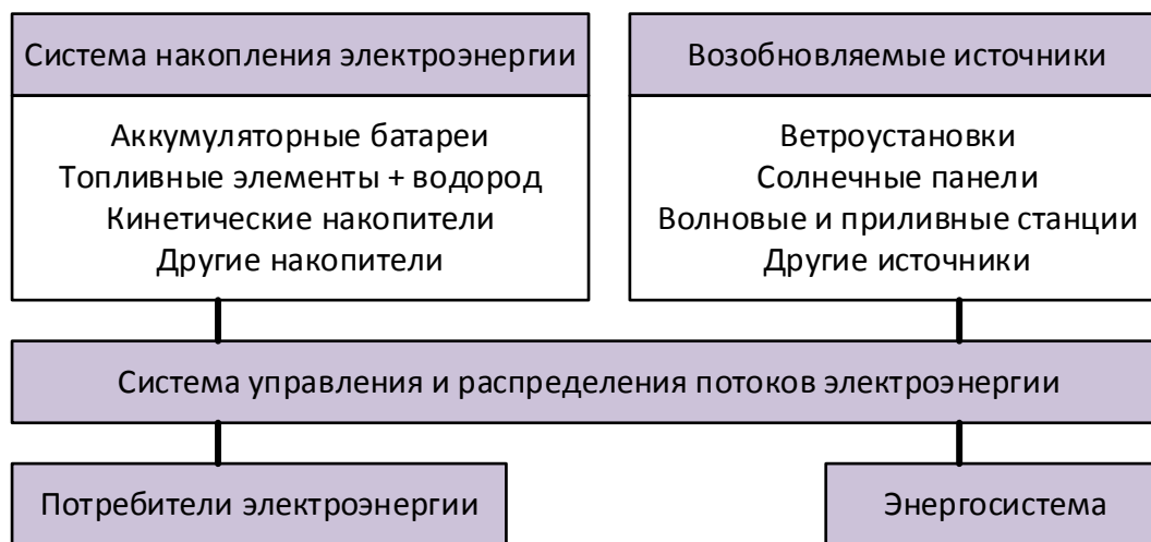
Рис. 3. Принципиальная схема концепции микрогрид системы электроснабжения порта
