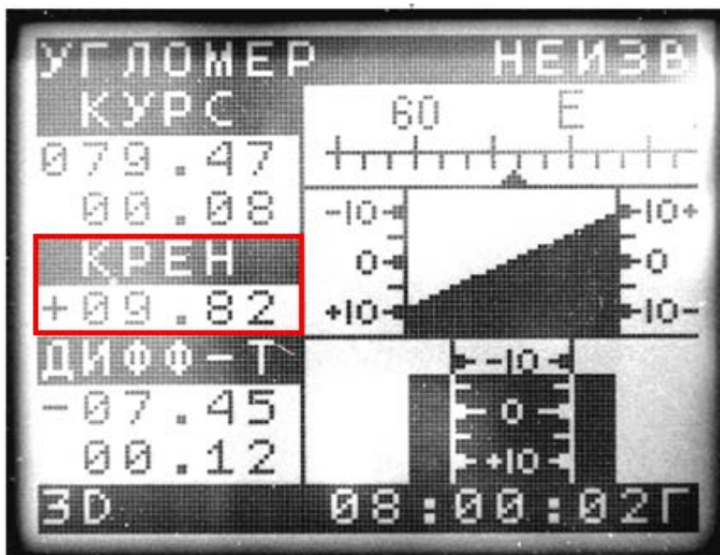
Рис. 2. Изображение формуляра РК-2306 «Фарватер» с информацией об угле крена
