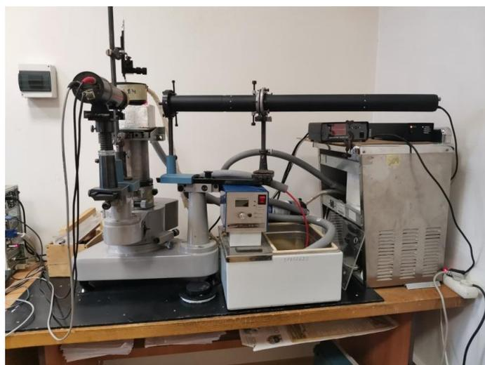
Рис. 2 Экспериментальная установка исследования коэффициента диффузии методом ФКС
