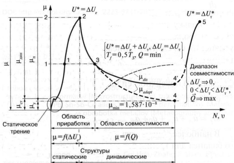
Рис. 3 Структурно-энергетическая диаграмма эволюции трущихся поверхностей [5]. Обозначение на осях: N, v - нагрузка и скорость. \mu_{ст}, \mu_{дин}, \mu_{упр}, \mu_{пл} - статический, динамический, упругий, пластический коэффициенты трения; T_f, T_S - температура вспышки в контактном объеме трения в точке 3 и температура плавления.
