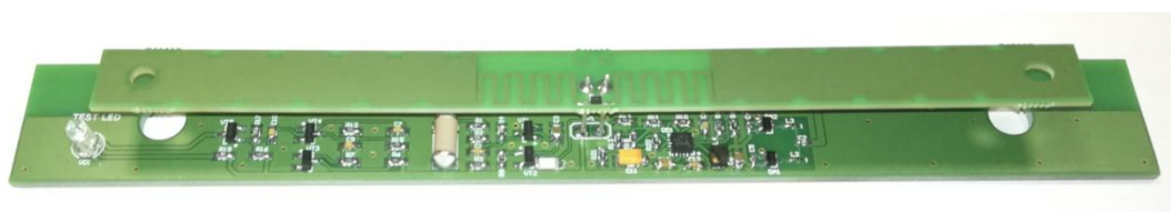
Рис. 6. Изготовленный беспроводной датчик перемещения
