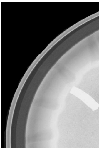
Рис. 3. Рентгенограмма закаточного шва с дефектом по ширине шва
