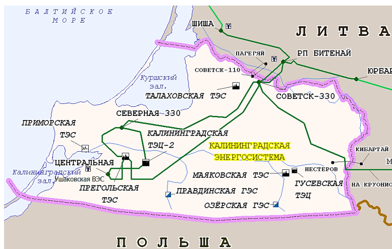
Рис. 3. Схема электроэнергетического сектора Калининградской области
