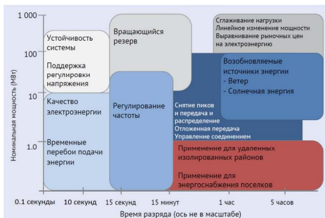
Рис. 9. Системы накопления электроэнергии для решения задач в энергосистеме и у потребителей [10]
