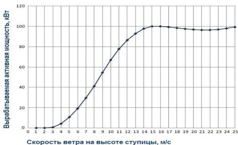
Рисунок 6 – Внешний вид и зависимость вырабатываемой активной мощности ВЭУ модели NPS 100-21 Arctic от скорости ветра на высоте ступицы
