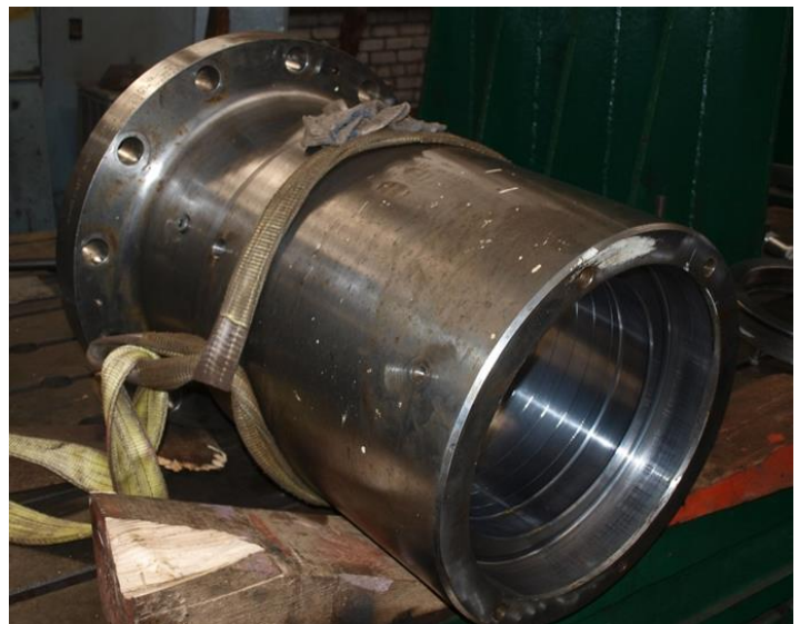
Рис. 3. Полумуфта гребного вала. Вид на кормовой конец
