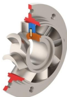
Рис. 6. Визуализация 3D-модели сборки колеса рабочего, выполненного по традиционной технологии [12]
