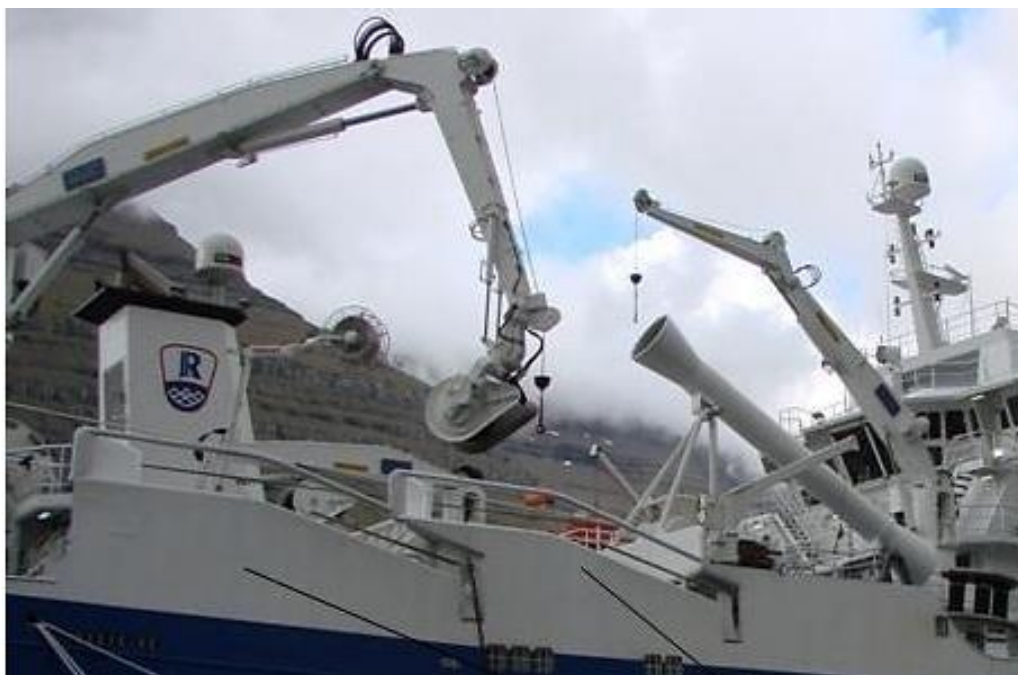
Рис. 1. Неводовыборочная машина траулера-сейнера «Ленинец»
