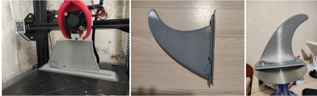
Рис. 10. Процесс печати (слева) и напечатанное изделие (справа)
