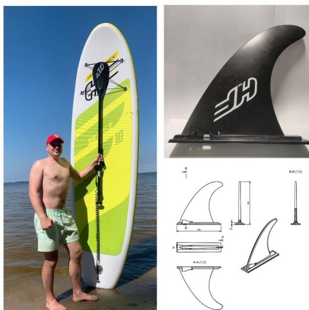
Рис. 3. Сап-доска (слева), оригинальный плавник и его чертежи (справа)
