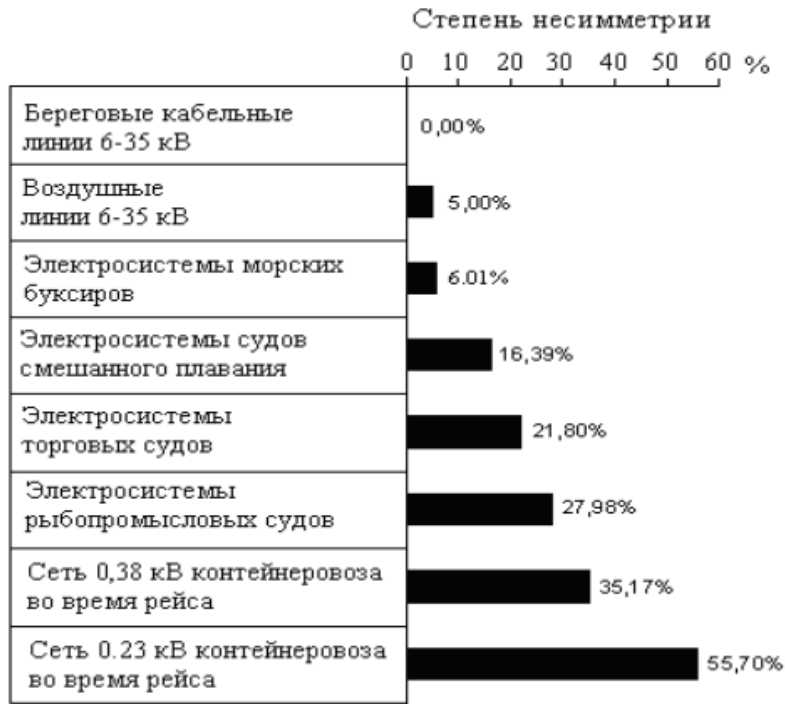
Рис. 1. Результаты измерения степени несимметрии фазных емкостей
