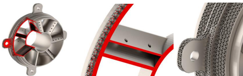
Рис. 13. Оптимизированная 3D-модель колеса рабочего [12]
