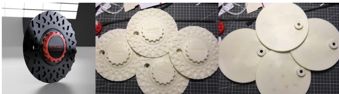
Рис. 8. 3D-модель и напечатанные колпачки дисков Remotec R16
