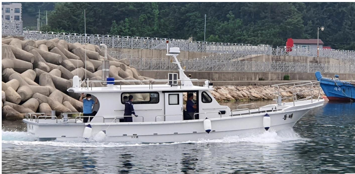
Рис. 1. Судно пр. KFB13 построено в Корее для местного рынка (проект AMD), длина L=13.3 м, ширина B=3.4 м, полное водоизмещение \Delta=12 т. Корпус судна выполнен из композитных материалов. Габариты судна и архитектура обусловлены «вписыванием» проекта в ограничение по регистрационной вместимости
