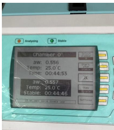
Рисунок 1- Анализатор активности воды «LabMaster-Aw»
