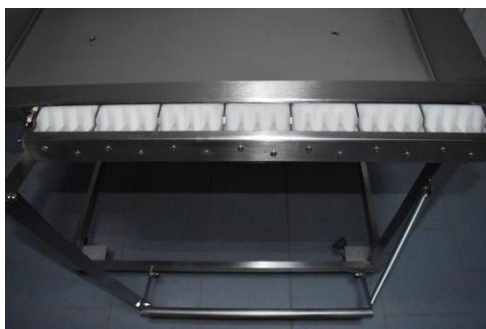
Рис. 1. Стол для ручной наколки рыб
