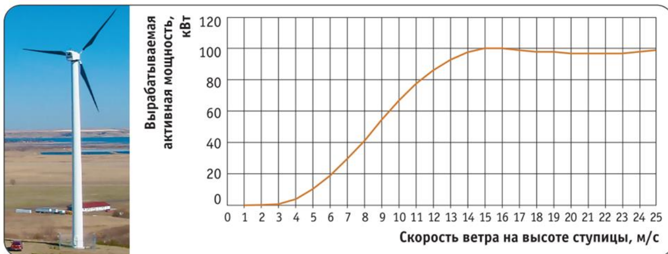
Рис. 3. Внешний вид и зависимость вырабатываемой активной мощности ВЭУ модели NPS100-21 Arctic от скорости ветра на высоте ступицы
