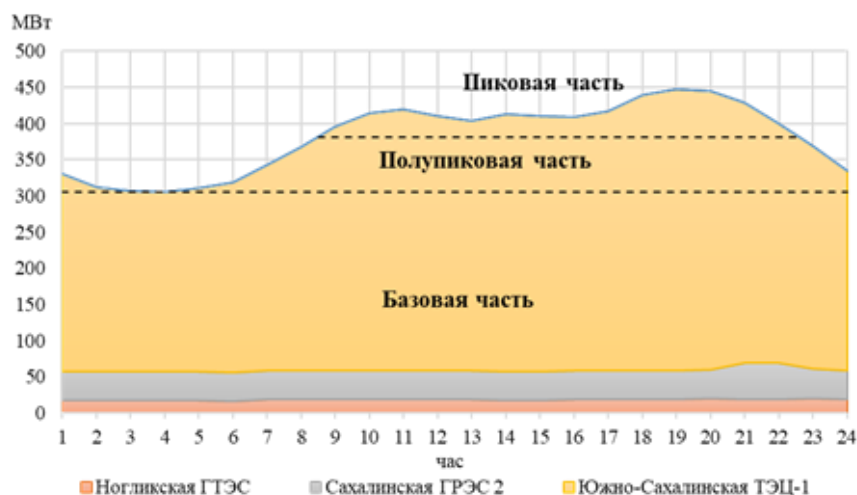
Рис. 1. Пример работы электрических станций изолированной ЭС о Сахалин в суточном графике нагрузки
