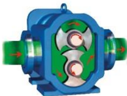
Рис. 3. Принципиальная схема действия кулачкового насоса
