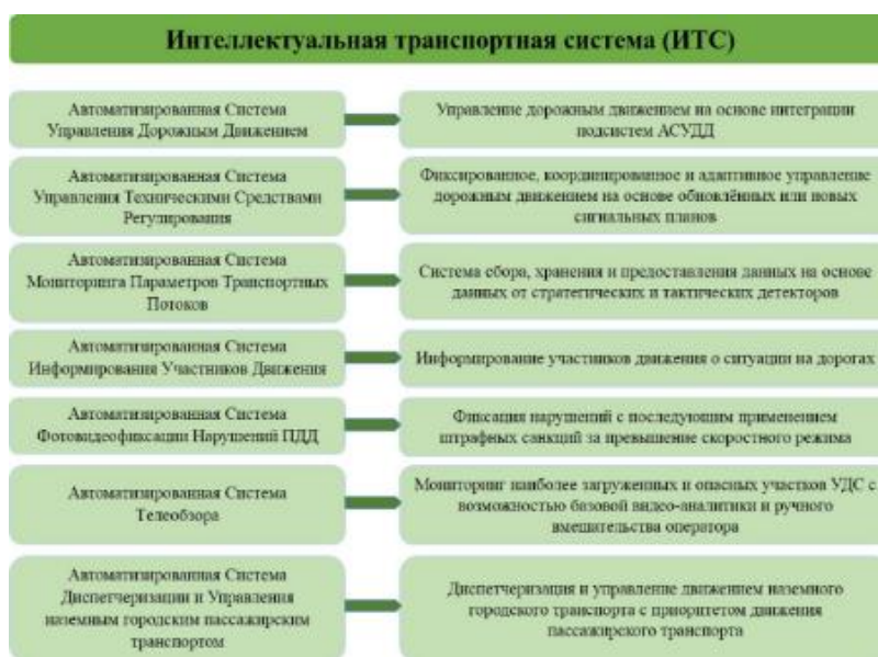
Рис. 1. - Структурные элементы ИТС и их функциональное назначение / Источник: [3]
