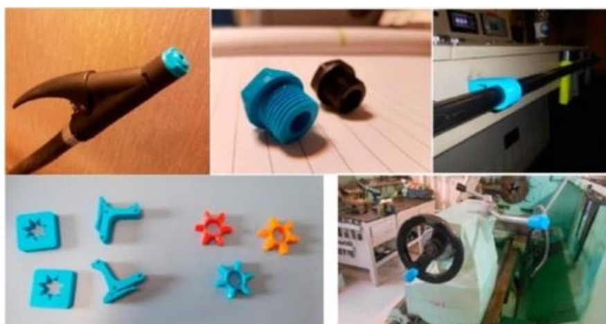
Рис.11. Компоненты, напечатанные на борту корабля [17]
