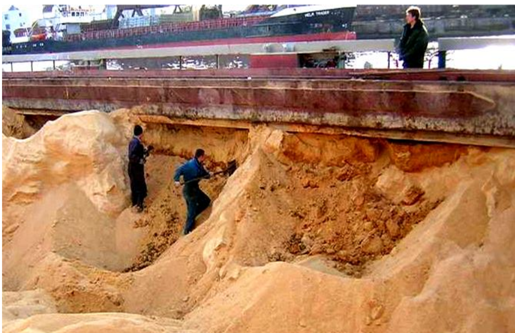
Рис. 1 Шрот, подмокший из-за текущих люковых крышек
