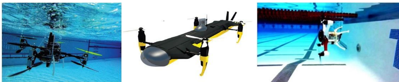
Рис.6. Примеры двухсредных беспилотных летательных аппаратов – слева-направо: «Naviator», «SubMurre», «Loon Copter» [15, 16]
