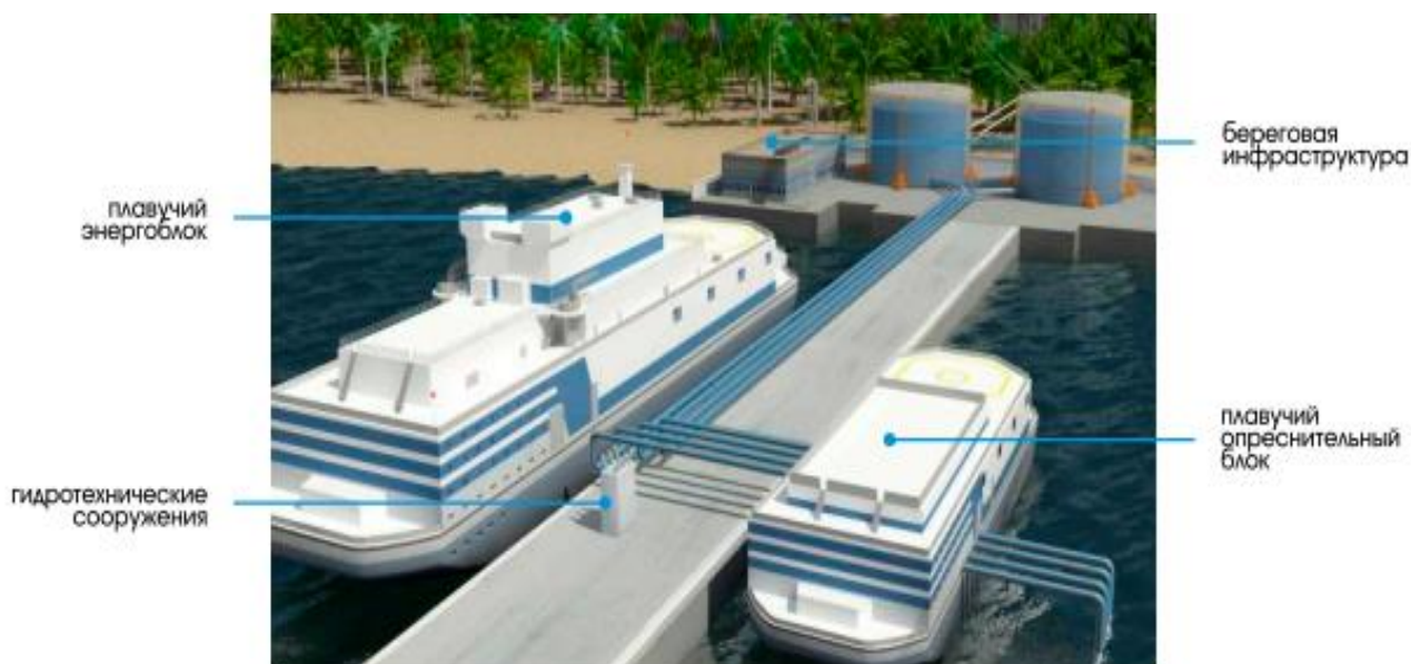
Рис. 1. Плавучий атомный энергоопреснительный комплекс ПАТЭС «Академик Ломоносов» с реакторными установками КЛТ-40С
