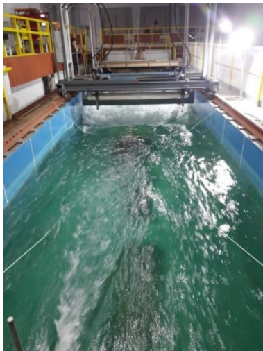
Рис. 1. Эксперименты с плавучим якорем в гидроканале ООО «Фишеринг Сервис»
