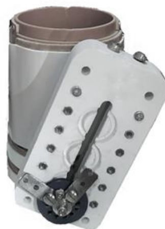
Рис.2. Блок Предплечья (Б) и Блок лучезапястного сустава (В) в соединении, вид снизу и сзади.
