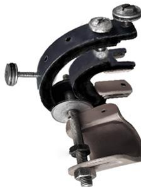
Рис.4. Узел контроля позиционирования и движения большого пальца кисти
