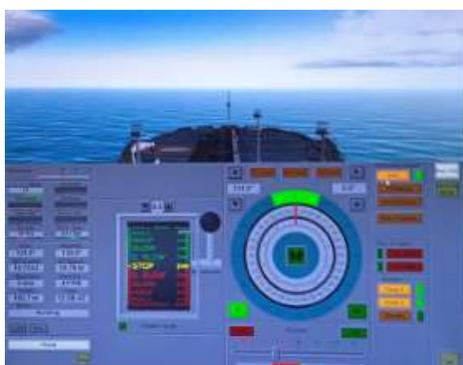
Рис. 13. Установка руля на автомат после выполнения отворота
