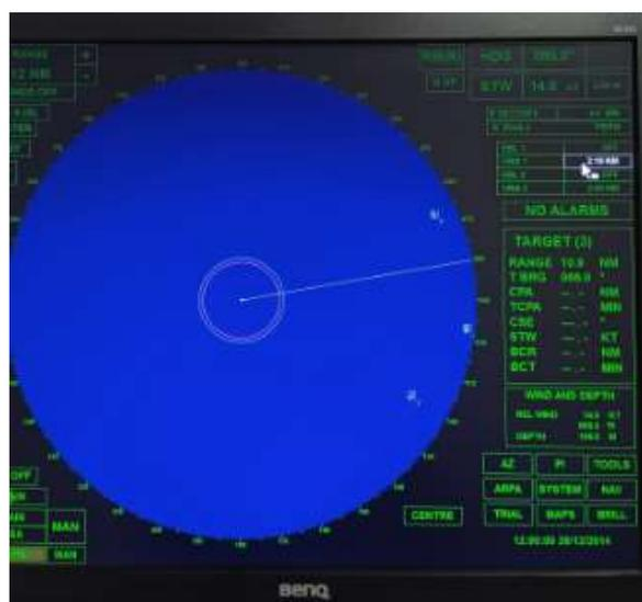
Рис. 5. Монитор РЛС с взятыми на сопровождение целями
