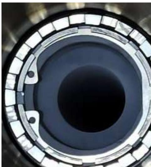
*Рис. 2. Переходная гайка в зацеплении*
