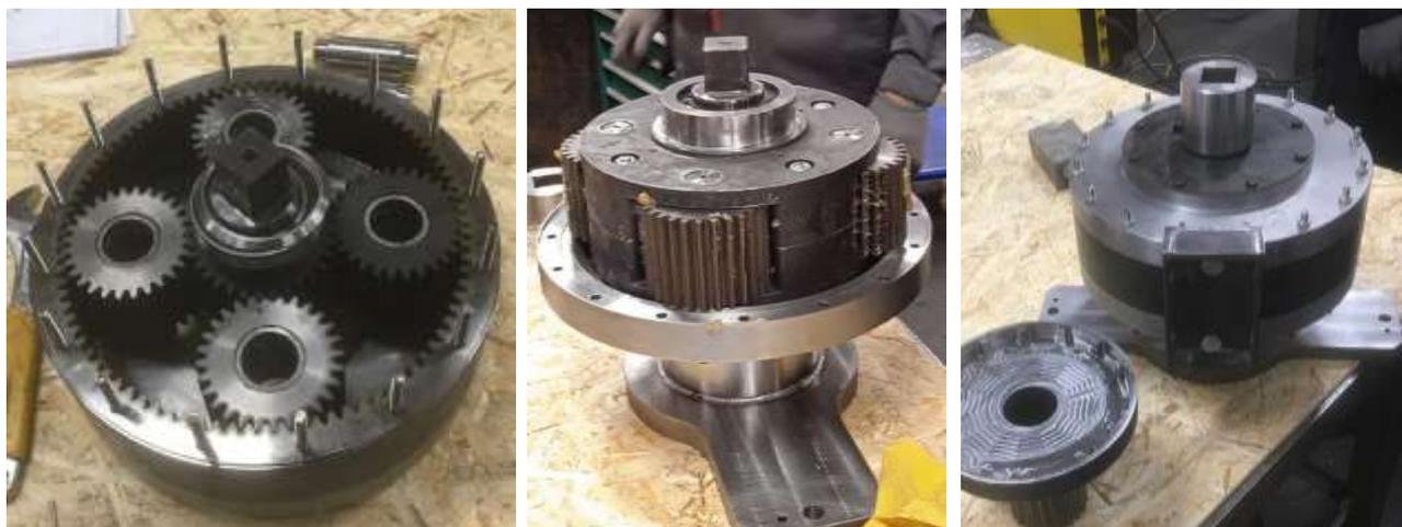
*Рис. 15. Планетарный мультипликатор в процессе сборки*
