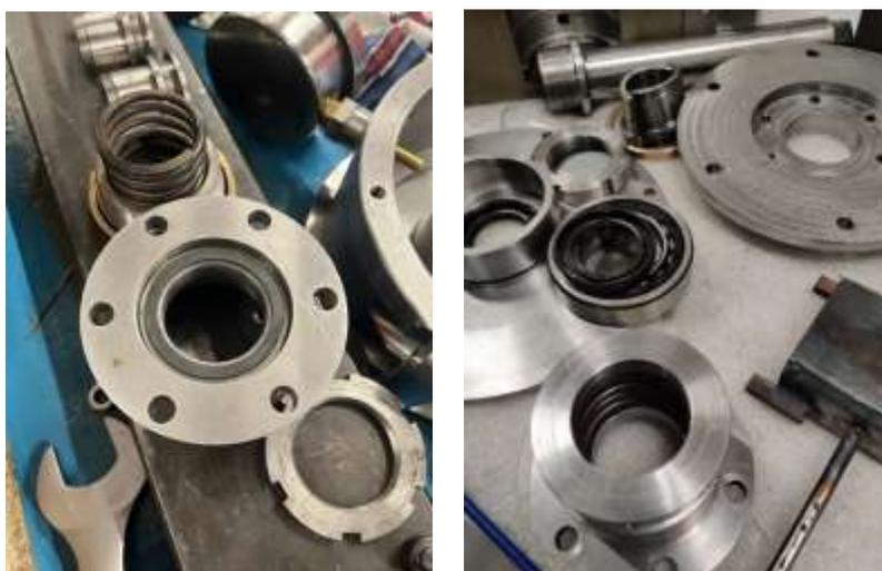
Рис. 4. Изготовленные детали торцевого уплотнения
