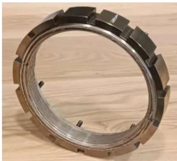
*Рис. 16. Отвинченная переходная гайка*
