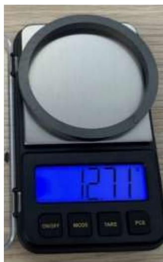
Рис. 5. Процесс взвешивания колец пары трения
