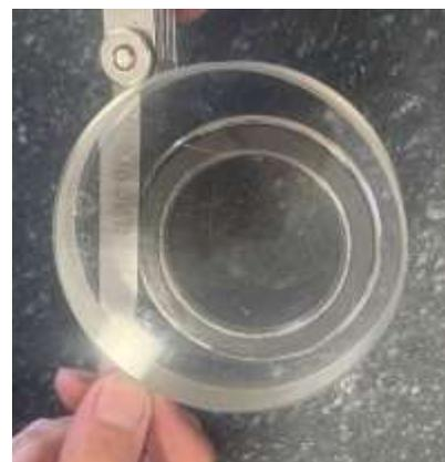
Рис. 6. Процесс измерения шероховатости и плоскостности контактных поверхностей
