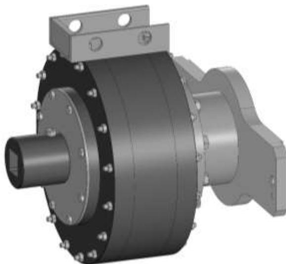
Рис. 10. 3D модель планетарного мультипликатора
