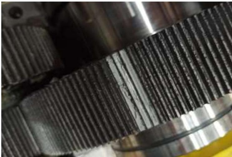
Рис. 8. Срезанные зубья колеса второй ступени
