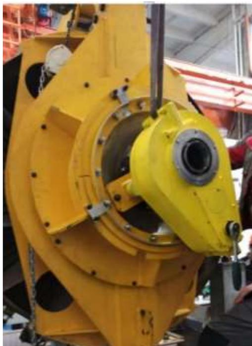
*Рис. 7. Мультипликатор установленный на траверсе*
