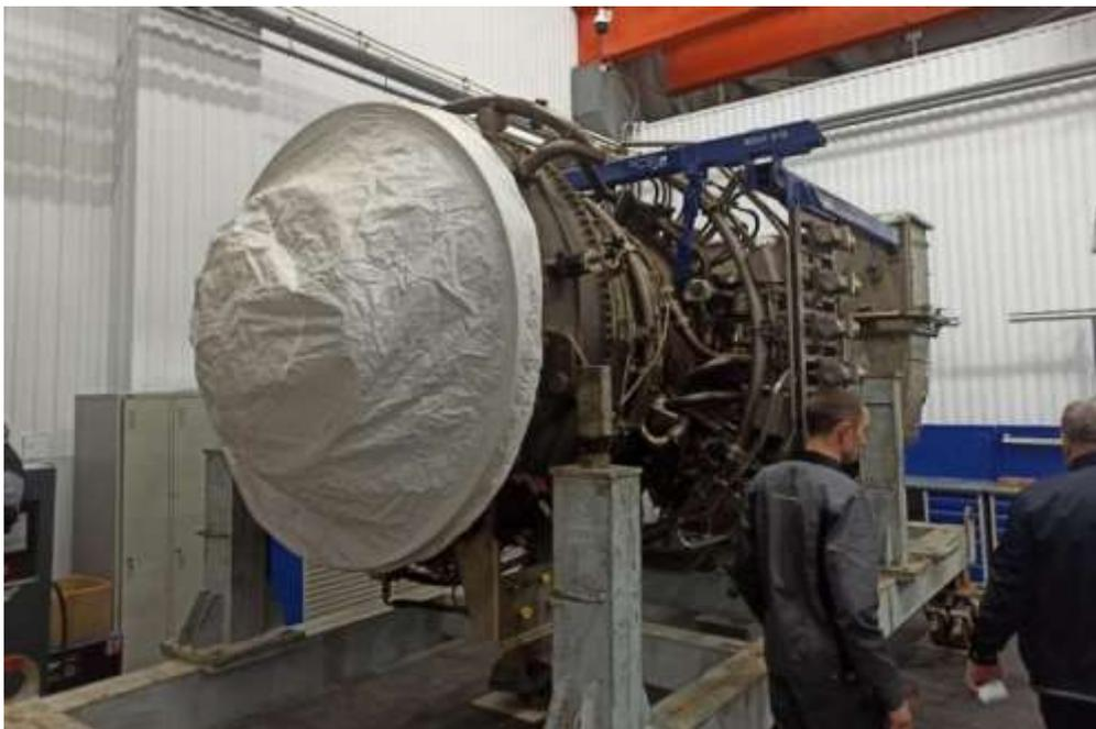
*Рис. 1. Двухвальная газовая турбина LM6000*
