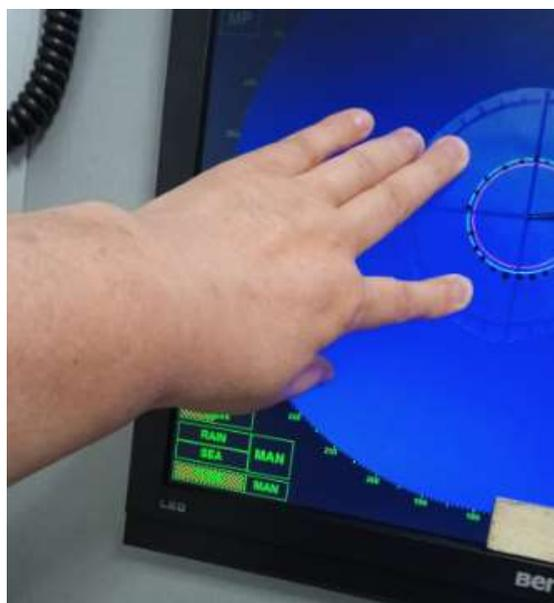
Рис. 6. Нанесение вектора нашей скорости и КМВ в принятом масштабе
