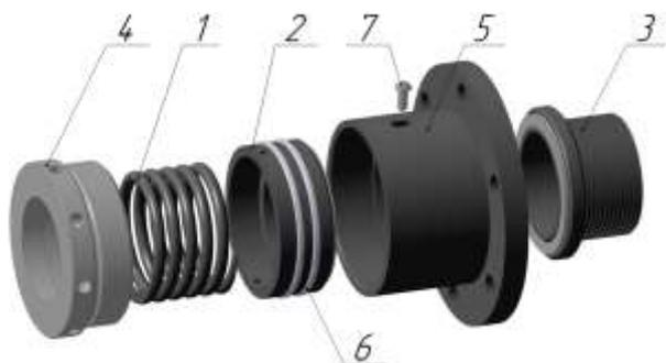
Рис. 2. Модель торцевого уплотнения
