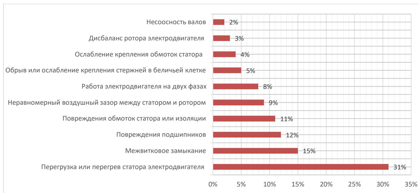
Рис. 2. Основные причины и источники возникновения и развития повреждений асинхронного двигателя [5]
