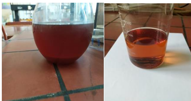
Рис. 3. Биодизель, полученный в ходе кислотного гидролиза из жира скумбрии, не очищенный (слева) и очищенный (справа)
