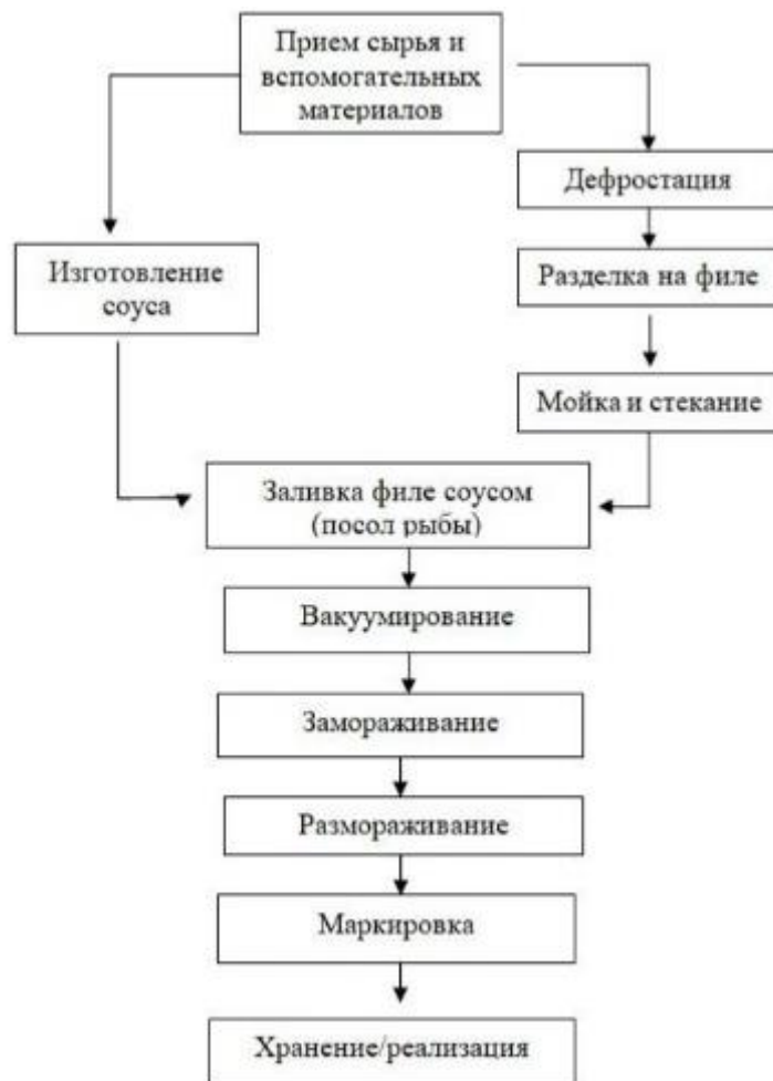
Рис. 1. Технологическая схема производства пресервов из сардины тихоокеанской (иваси) в горчичном соусе
