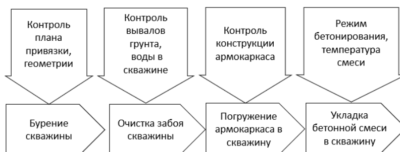
Рис. 2. - Общая схема контроля качества процесса устройства буронабивных свай
