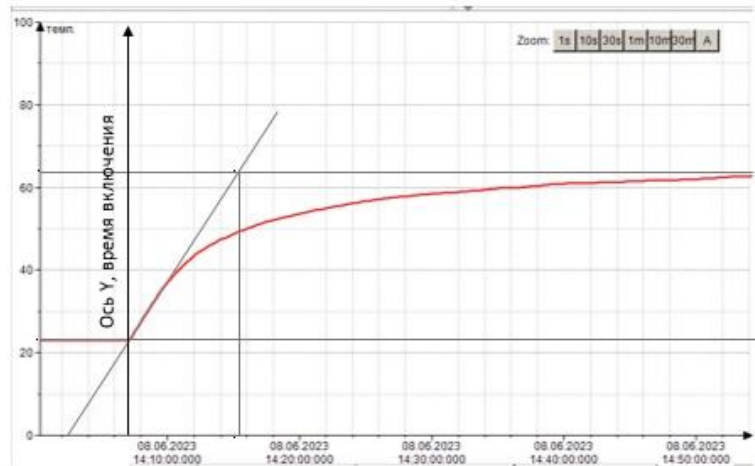
Рис.11. Кривая разгона при мощности нагревателя 60 Вт
