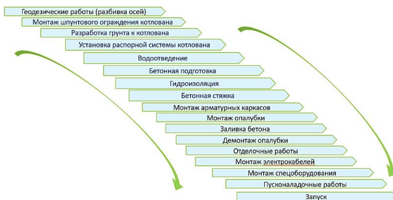
Рис. 1. Этапы выполнения подготовительных и строительно-монтажных работ для инфраструктурного объекта – пешеходный переход на остановочном пункте Новогиреево
