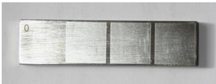
Рис. 3. Заготовка после обработки лазером
