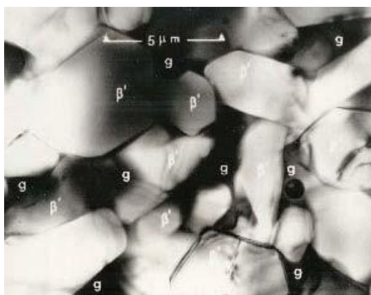
Рис. 2. Зерна сиалона \beta в окружении стеклофазы g
