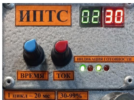
Рис.2. Цифровая и светодиодная индикация параметров сварки и готовности оборудования к проведению процесса
