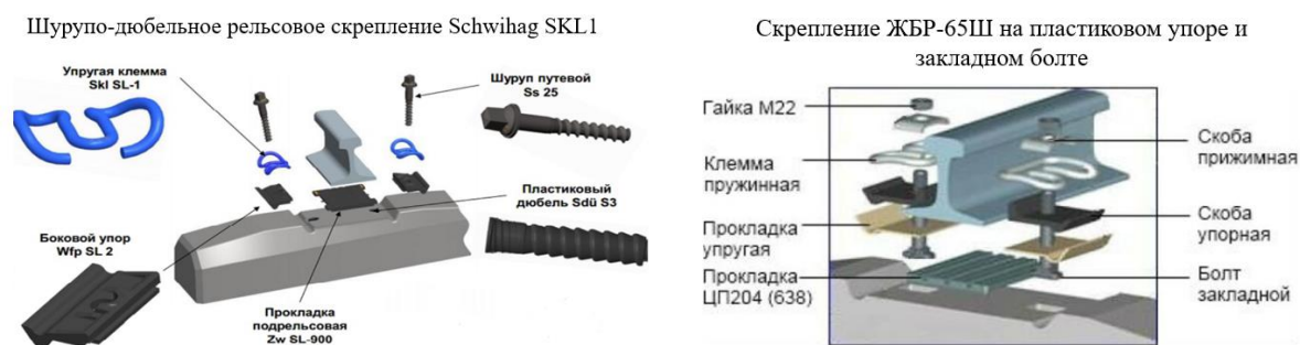
Рис. 2. Конструкция конструкции шурупно-дюбельных упругих рельсовых креплений
