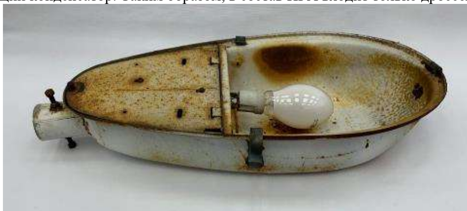
Рис. 4. Устаревший светильник типа РКУ 125
