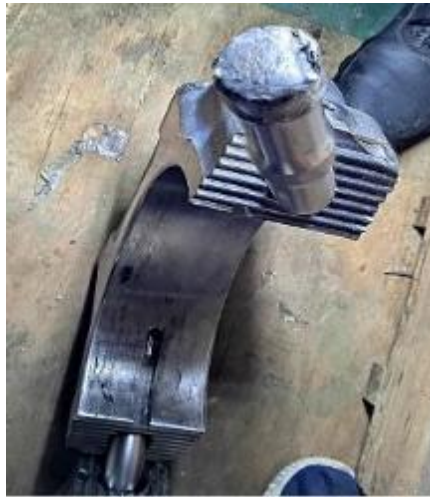
Фото 14. На поверхности зубчатого разъёма нет следов наклёпа.
