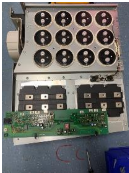
Рис. 1. Модуль одной фазы частотного преобразователя в разобранном состоянии
