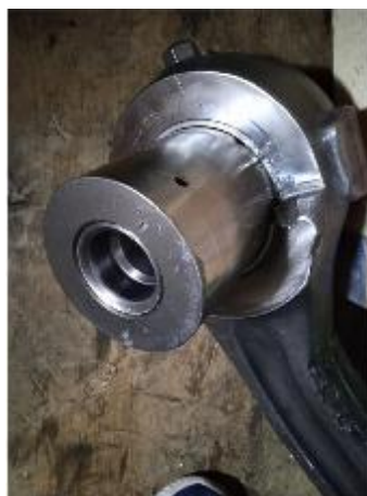
Фото 8. Следы ударов по боковой поверхности стержня, вызвавшие искривление стержня шатуна
