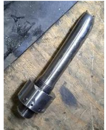
Фото 15. Разрыв шпильки с образованием галтели от растягивающего усилия.
