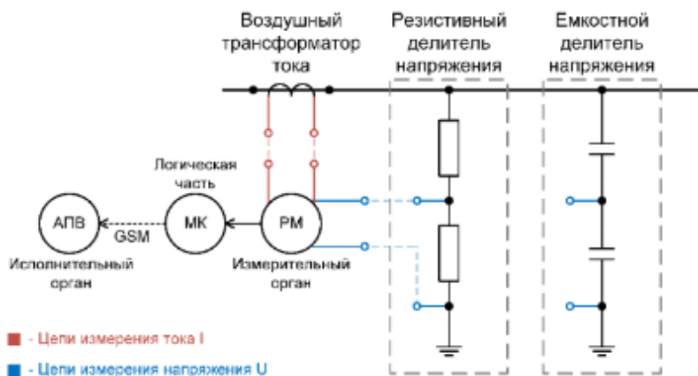
Рис. 6. Принципиальная схема УРПНМ
