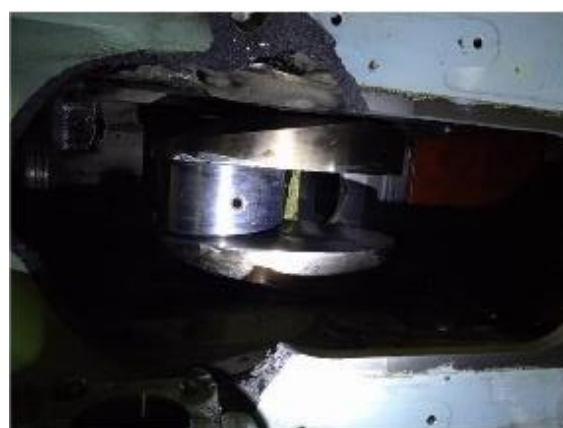
Фото 22. Повреждение картера в районе вырванных лючков.
