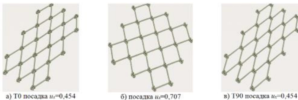
Рис. 3. Участок узловой дели d/a=0,08
