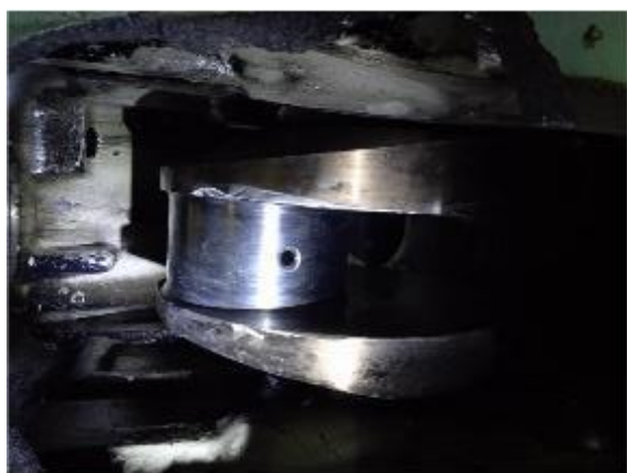
Фото 21. Следы ударов разрушенных деталей о коленчатый вал.
