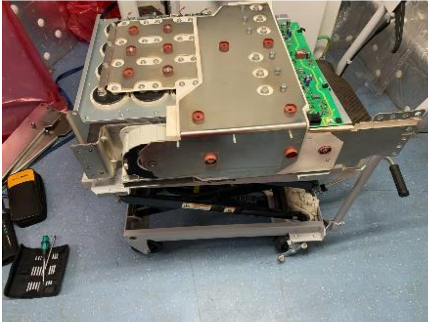
Рис. 3. Модуль одной фазы частотного преобразователя в сборе
