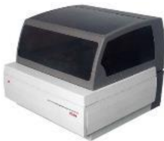
Рис. 4. Универсальный рентгенофлуоресцентный энергодисперсионный спектрометр PEAN
