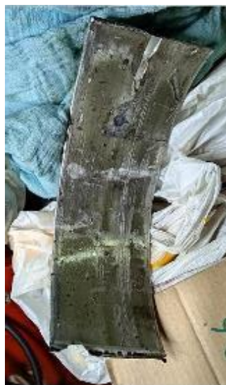
Фото 17,18. Вкладыши нижнего подшипника со следами деформации.
