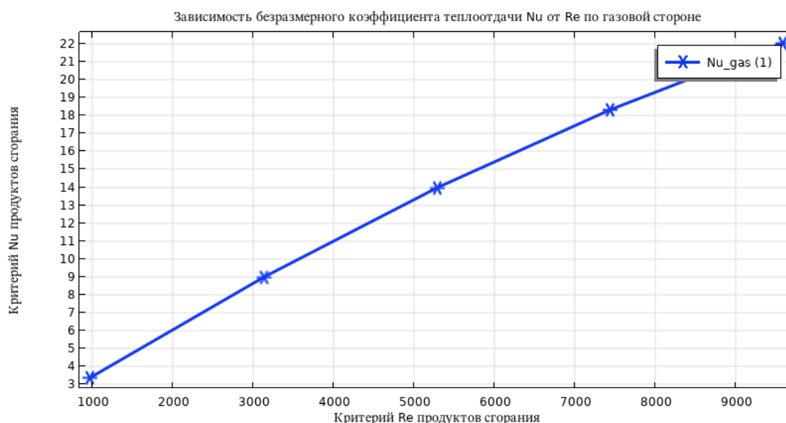
Рис. 6. Зависимость безразмерного коэффициента теплоотдачи Nu от Re по газовой стороне
