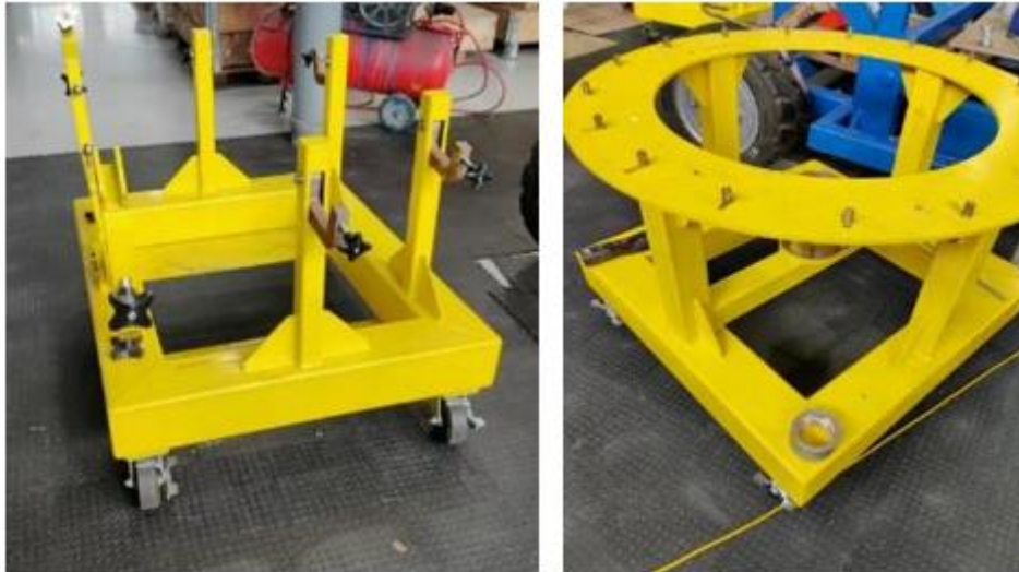
Рис. 9 Изготовленные платформы хранения а) платформа транспортировки и оперативного хранения модуля ТВД после демонтажа; б) платформа долгосрочного хранения модуля ТВД
