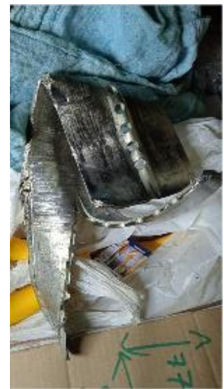
На рабочей поверхности нет видимых следов термического воздействия (трения)
