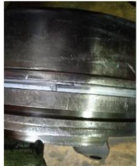
Фото 6. Отрыв головки поршня по канавке маслосъёмного кольца
