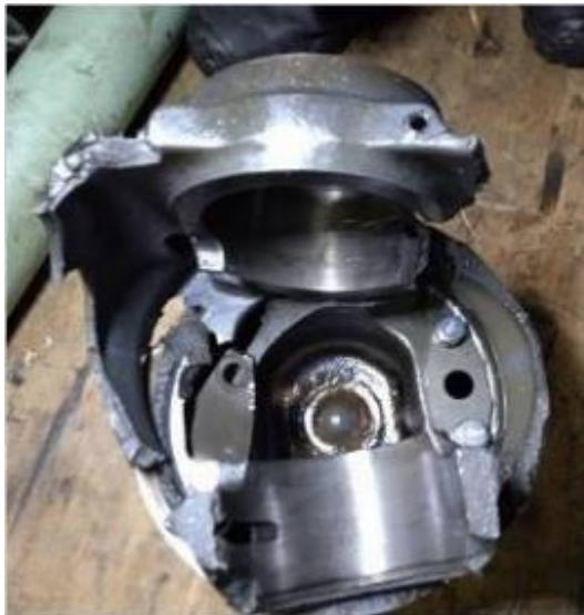
Фото 5. Разрушение тронка поршня
