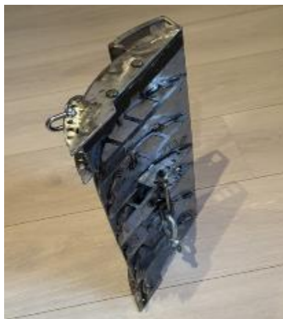
Рис. 3. Модель разноглубинной траловой доски крыловидной формы
