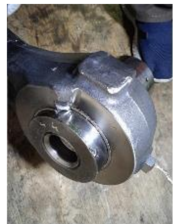
Фото. 9. Следы ударов на верхней головке и поршневом пальце
