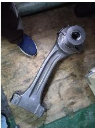
Фото. 7. Деформация стержня шатуна
