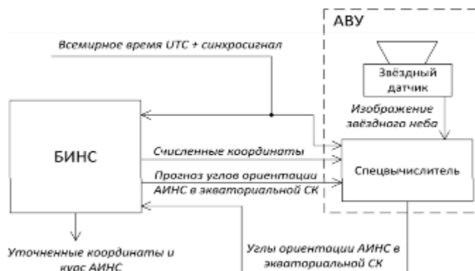
Рис. 3 Структура функционирования морской астроинерциальной навигационной системы при определении места судна и поправки курсоуказания с использованием звездного датчика
