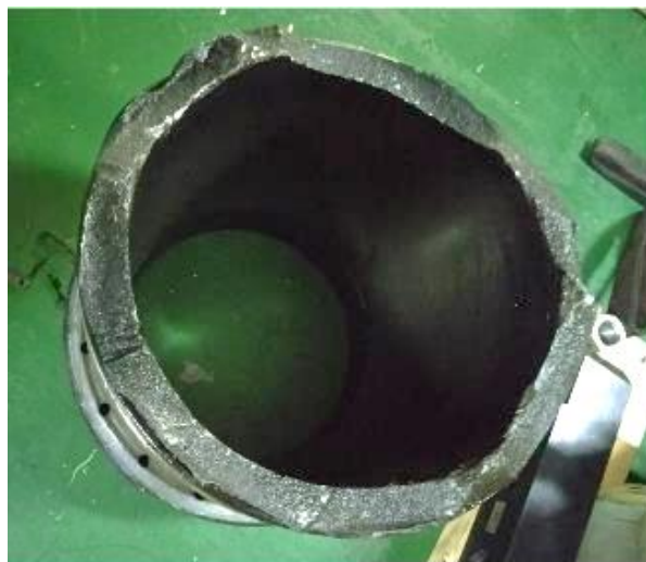
Фото 20. Разрыв втулки цилиндра
