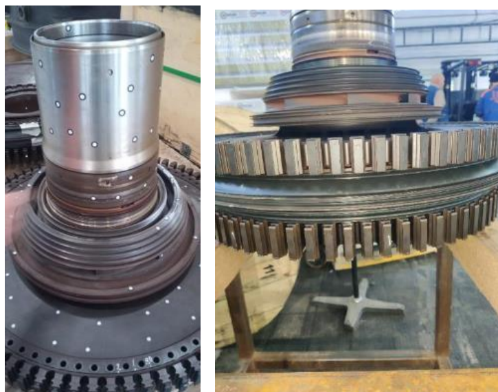
Рис. 11 Демонтированный ротор ТВД в зоне хранения.
