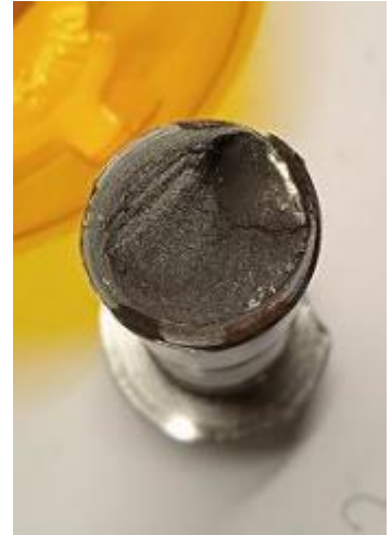
Фото 12. Разрыв болтов без видимых следов усталости металла
