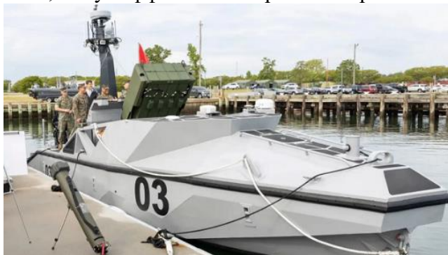
Рис. 4. Пусковая установка для БПЛА, установленная на морском носителе
