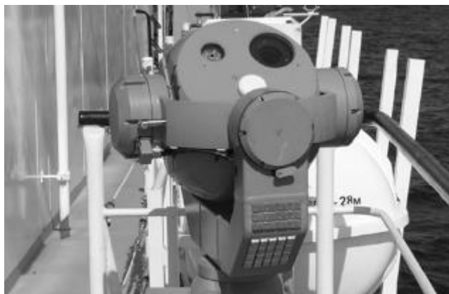
Рис.4 Общий вид экспериментального образца морской астроинерциальной навигационной системы с системой наведения и стабилизации в условиях качки, представленный Пермской научно-производственной приборостроительной компанией
