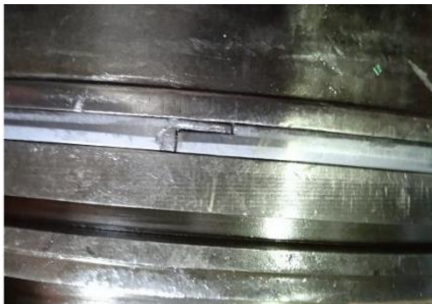
Фото 23. Верхнее поршневое кольцо со сколами в районе замка. Цилиндрическая поверхность головки поршня не имеет следов деформации (натиров, задиров).
