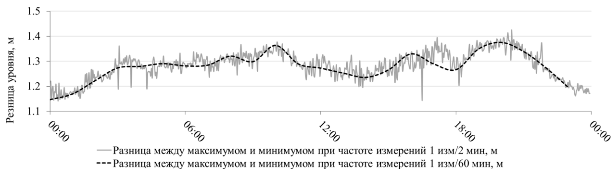
Рис. 5. Разница между максимальным и минимальным значением уровня воды в одни и те же сроки за период в течении дня в период с 4 мая 2023 г. по 12 сентября 2024 г.
