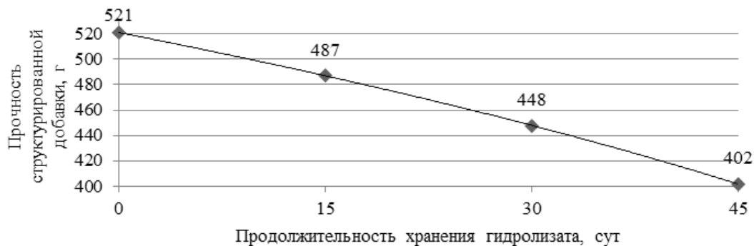
Рис. 2. Изменение прочности структурированной добавки в зависимости от продолжительности хранения гидролизата рыбного коллагена
