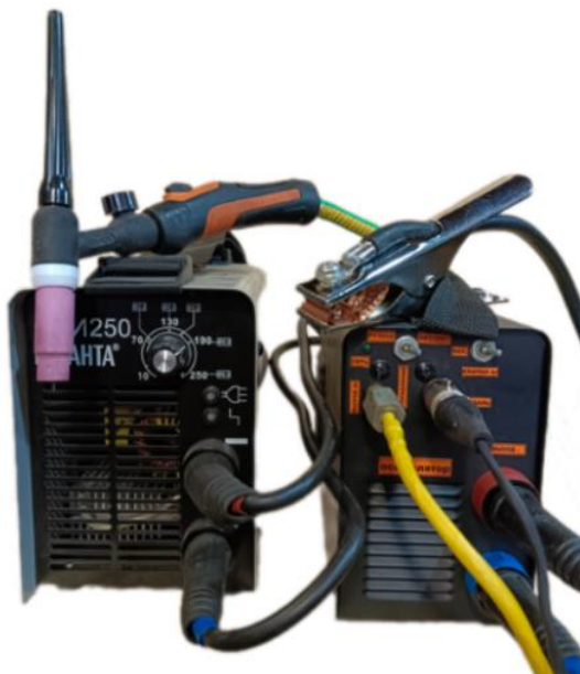
Рис.5. Сварочный инвертор настроен для работы неплавящимся вольфрамовым электродом в среде аргона
