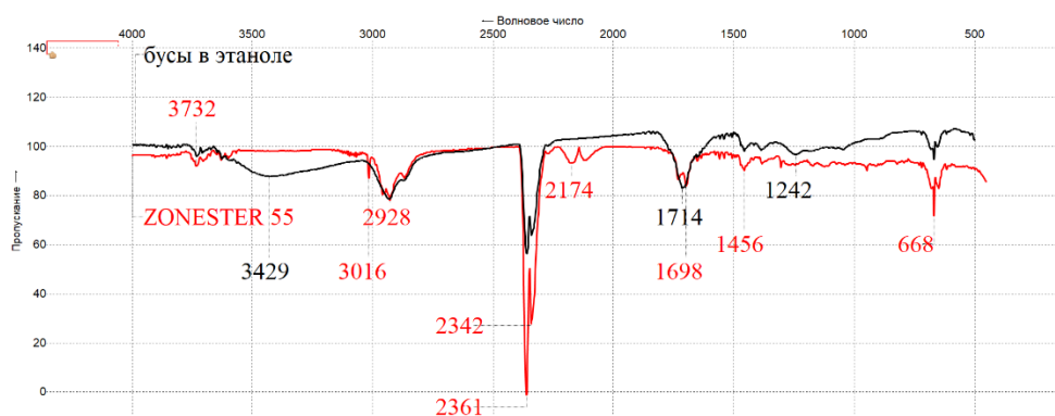
Рис. 11 Сравнение спектра исследуемого образца (черный) с библиотечным спектром ZONESTER 55 (красный).
