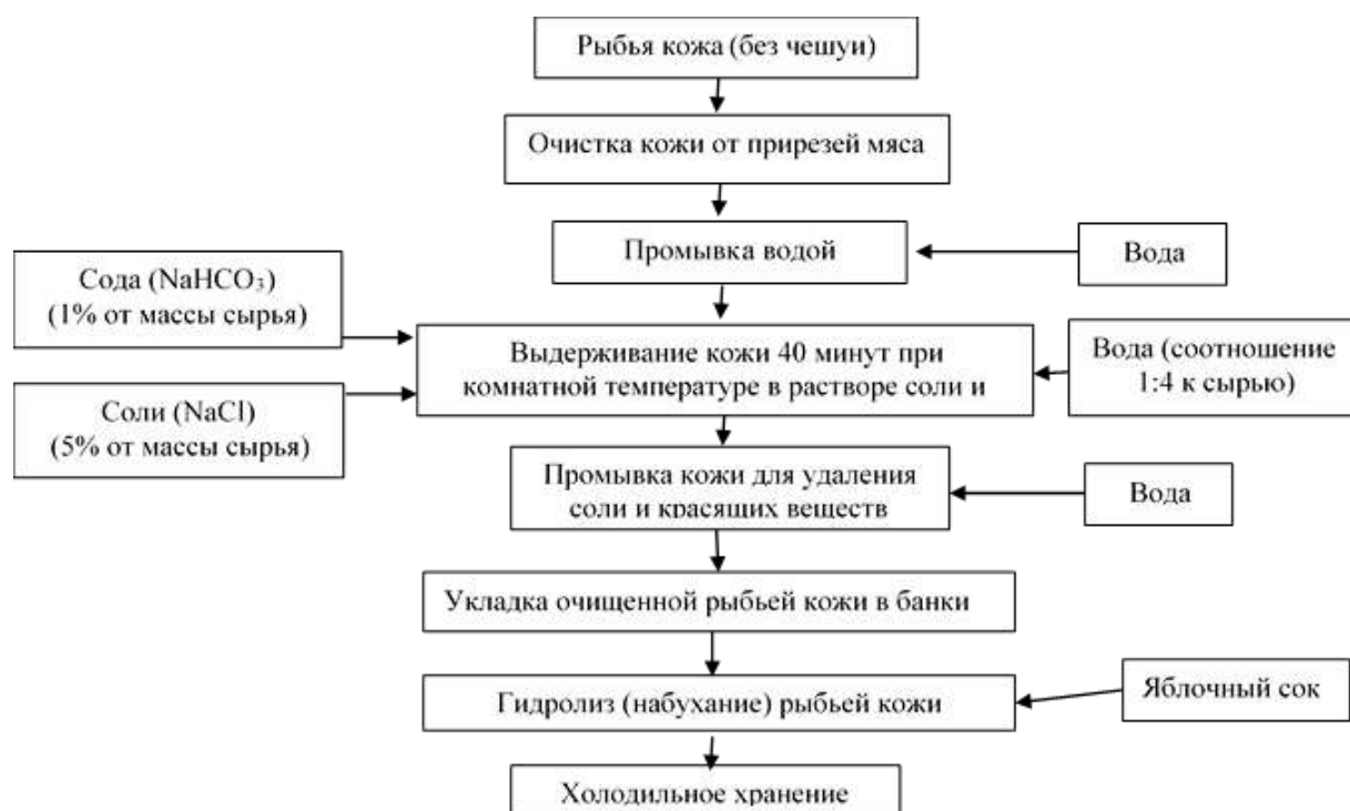
Рис. 1. Технологическая схема получения сокодержущего гидрата рыбьей кожи минтая (ГК)
