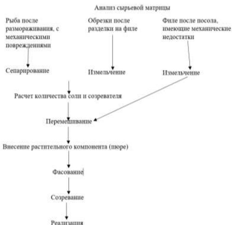
Рис. 3. Структурная технологическая схема изготовления модельных образцов пресервной пасты
