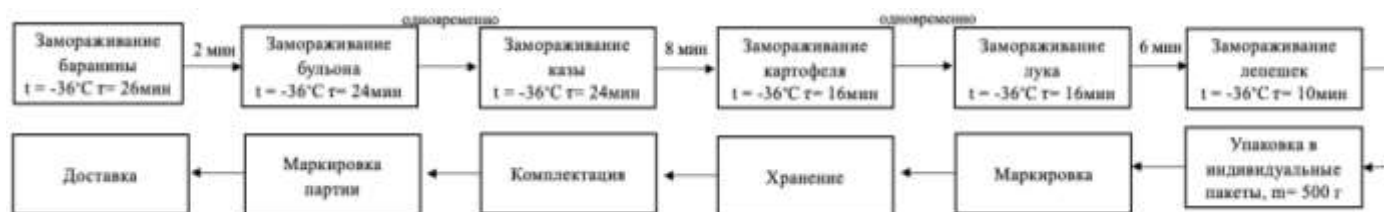
Рис. 2. Алгоритм размещения компонентов для одновременной заморозки
